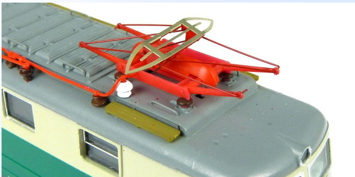
Obr. 8: Detailní pohled na sklopený sběrač. Ližina je nakloněná k jedné straně.
