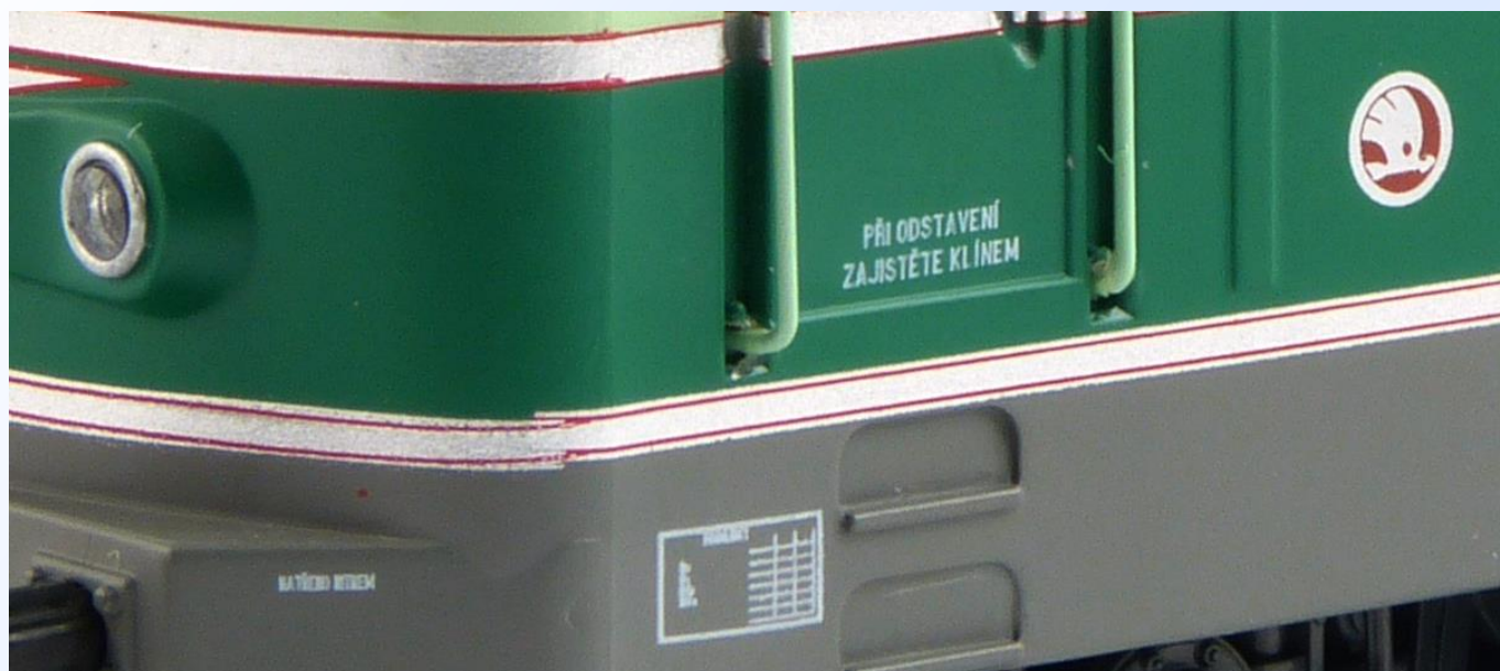
Obr. 7: Odskočení spodní stříbrné linky na přechodu bočnice a čela.
