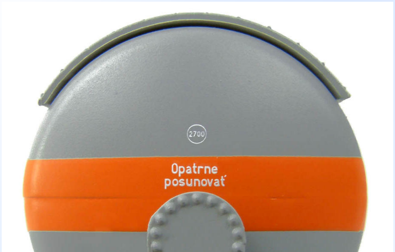
Obr. 10: Nedokonalosti spoje v oranžovém pruhu na kotli.
