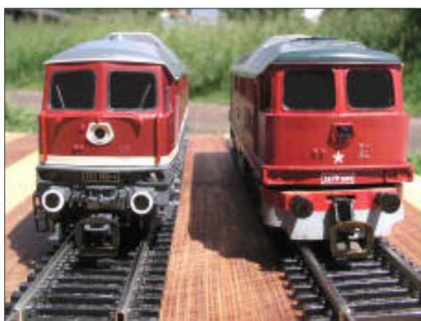
Obr.4 – Skříň BTTB modelu postrádá madla na čelech
