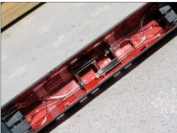
Obr.11 – Spleť světlovdů v útrobách skříně
