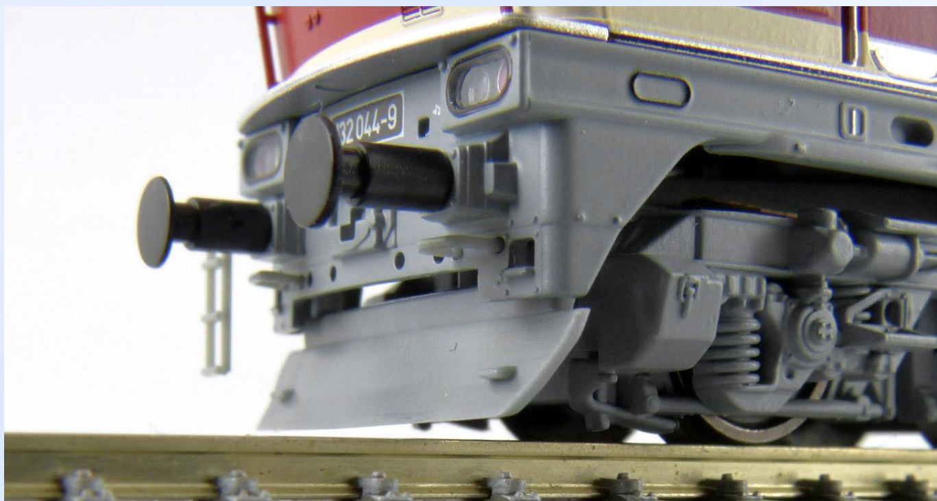
Obr. 13: Výška spodní hrany pluhu nad temenem kolejnice je necelý milimetr.
