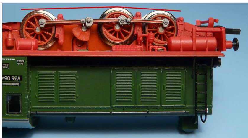
Obr. 8: Výkyvné uložení prostřední a zadní nápravy.
