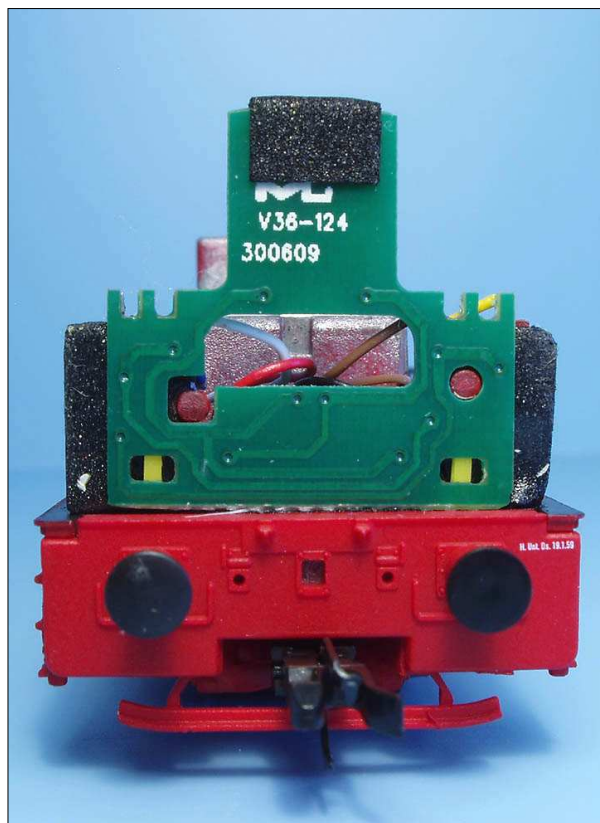
Obr. 11: Plošný spoj v budce strojvedoucího.
