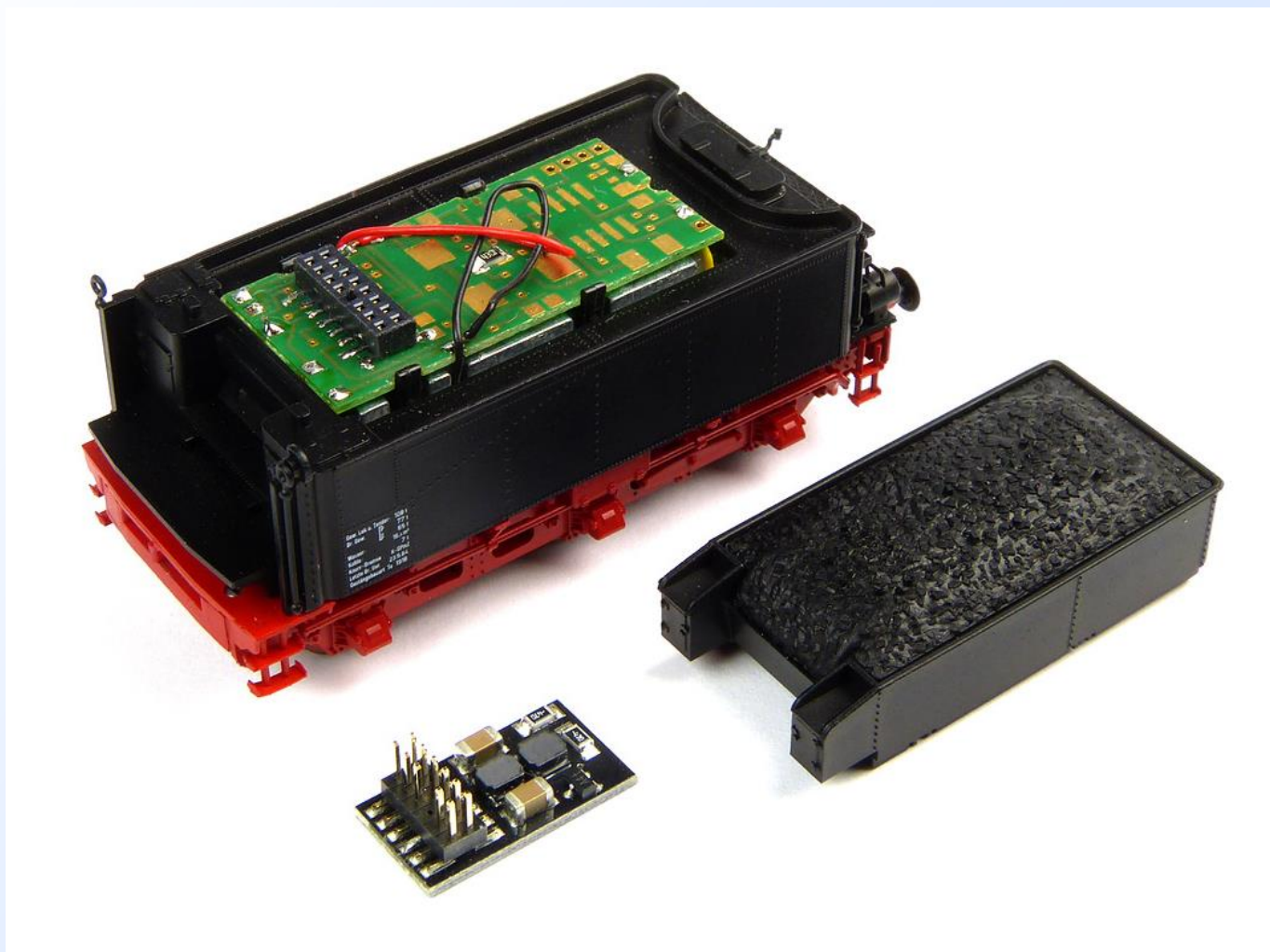
Obr. 10: DPS s rozhraním PluX16.
