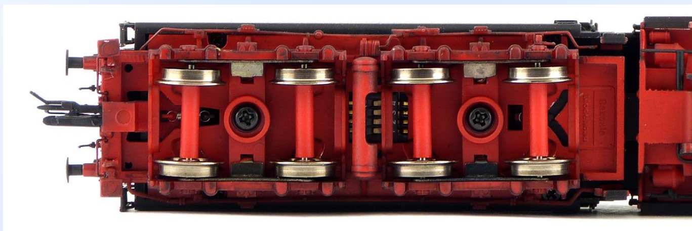
Obr. 7: Spodek tendru – mezi podvozky je patrný 4pólový přepínač na ovládání světelných funkcí v analogovém režimu.
