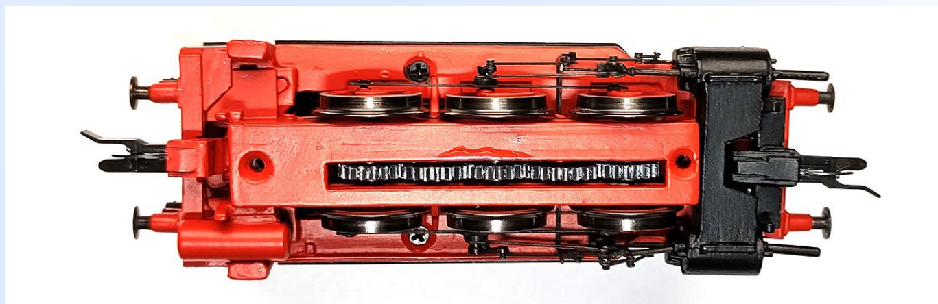
Obr. 10: Pohled na odkrytou převodovku.
