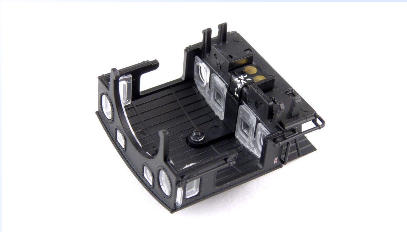
Obr. 13: Pohled do budky. Zde je vidět lampa osvětlení a kontaktní plošky pro jeho napájení.
