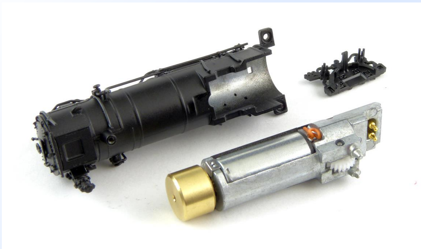
Obr. 11: Motor se setrvačníkem se ukrývá v dutině kotle.
