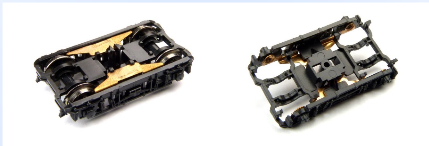
Obr. 9 a 10: Podvozek a uložení dvojkolí.
