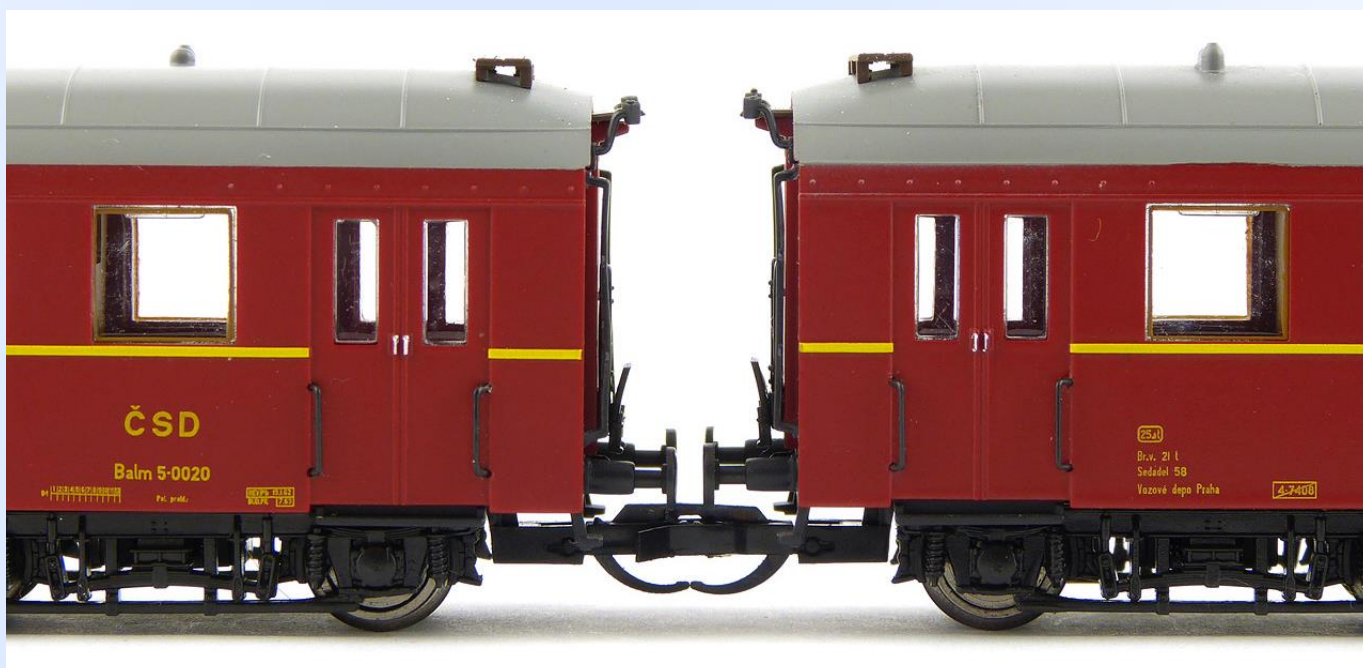
Obr. 7: Spojené vozy a mezera mezi nárazníky v tahu.
