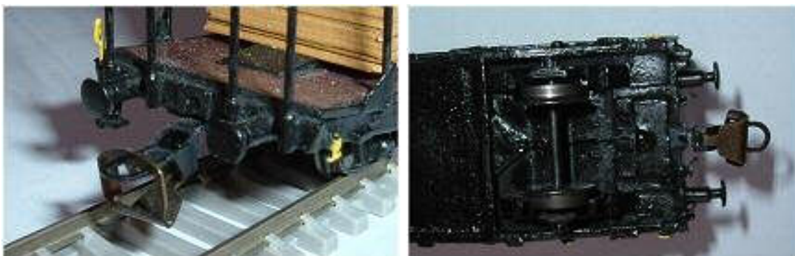
Obr. 185/186 - Otočné upevnění upraveného spřáhla BTTB se středící pružinou (pohled zepředu a zespodu)
