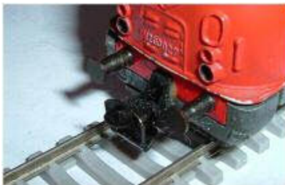
Obr. 171 - Spřáhlo BTTB osazené na čele lokomotivy V 200 místo původního spřáhla Zeuke
