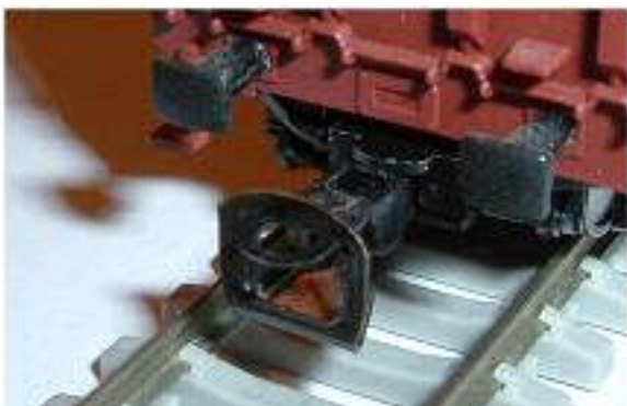
Obr. 49/50 - Spřáhlo do podvozku na vagonu a upevnění spřáhla v podvozku typu Y25
