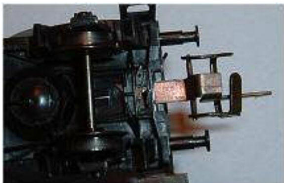
Obr. 21/22 - Upevnění spřáhla pomocí pružného drátku u dvouosých vagonů
