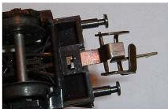
Obr. 21/22 - Upevnění spřáhla pomocí pružného drátku u dvouosých vagonů
