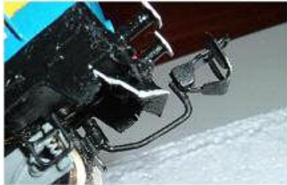
Obr. 205/206 - Upevnění spřáhla na lokomotivě T 499.0 (pohled z boku a celkový pohled na držák spřáhla)
