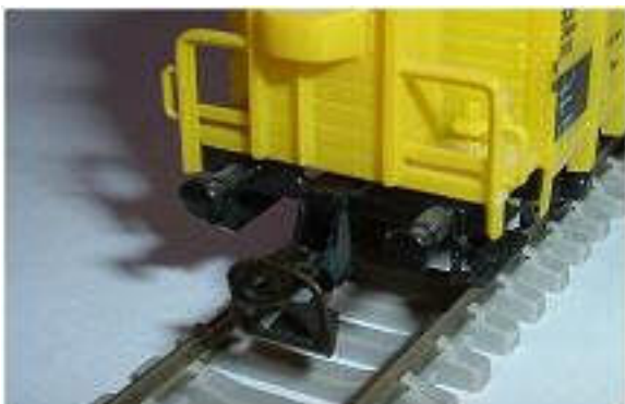
Obr. 177/178 - Ukázka náhrady průběžného spřáhla Zeuke upraveným spřáhlem BTTB (pohled zepředu a zespodu)
