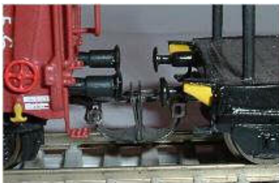
Obr. 87 - Spřažená dvojice „D“ spřáhel
