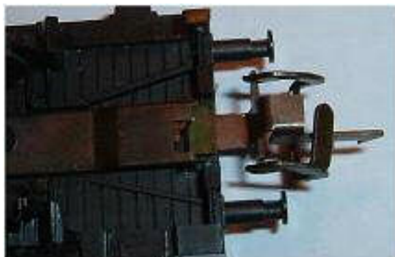
Obr. 21/22 - Upevnění spřáhla pomocí pružného drátku u dvouosých vagonů
