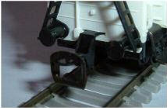
Obr. 46/47 - Spřáhlo BTTB s dlouhým trnem na vagonu a upevnění spřáhla BTTB na rychlíkovém voze
