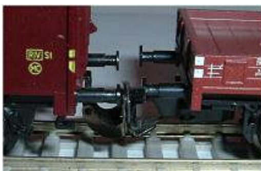
Obr. 153 - Detail (st.) + Tillig Vzdálenost nárazníků 2,5 / 3,5 mm
