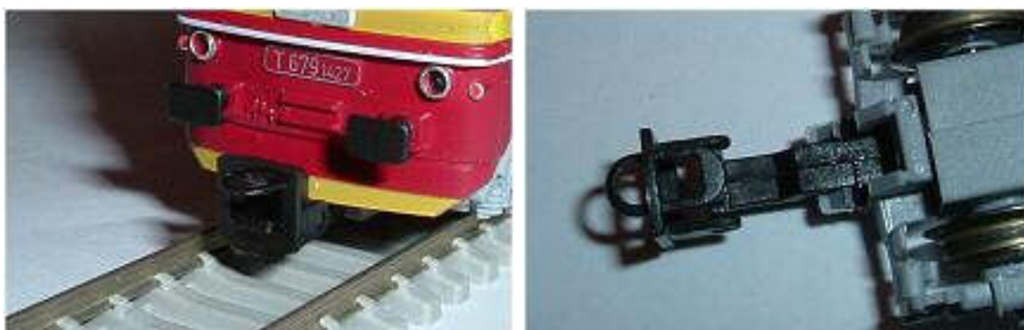
Obr. 119/120 - Lokomotivní spřáhlo Tillig na lokomotivě a jeho upevnění na podvozku
