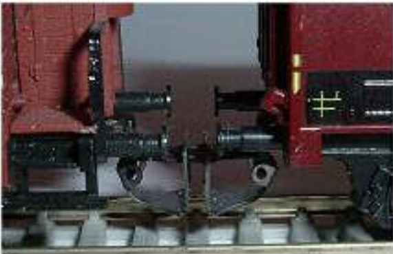
Obr. 82/83 - Ukázka spřažení dvojice spřáhel Detail (novější provedení)
