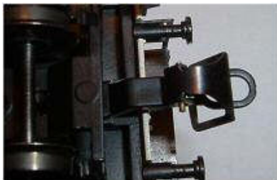
Obr. 126/127 - Spřáhlo Peresvet na chladícím voze Laghgrs s novým třmenem ze spřáhla Detail
