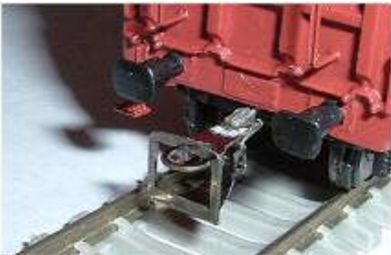
Obr. 84/85 - „D“ spřáhlo na čtyřosých vagonch
