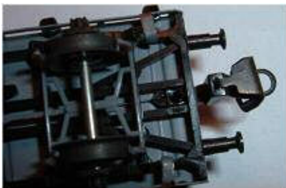
Obr. 181/182 - Ukázka náhrady průběžného spřáhla Zeuke upraveným spřáhlem BTTB (pohled zepředu a zespodu)
