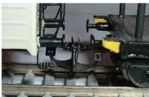
Obr. 160 - DK Model + Detail „D” Vzdálenost nárazníků 3,5 / 5,0 mm
