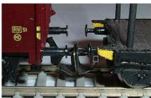
Obr. 144 - BTTB + Detail „D“ Vzdálenost nárazníků 4,0 / 6,0 mm
