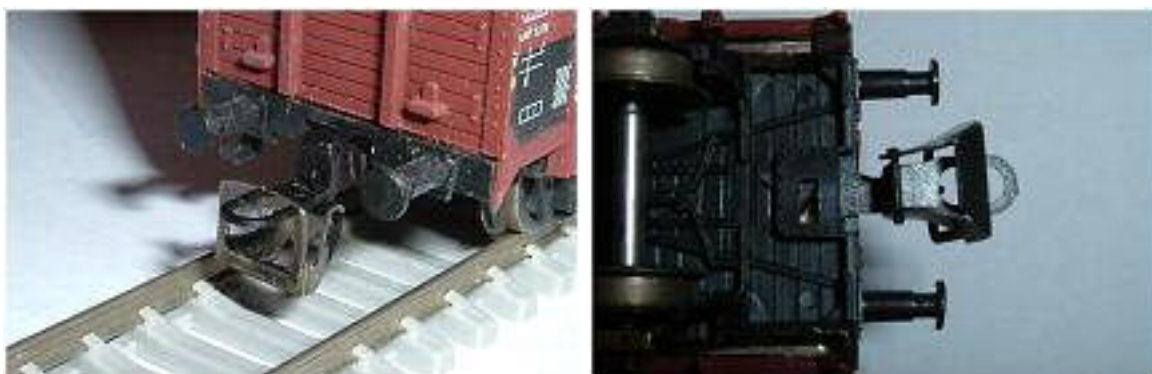
Obr. 76/77 - Spřáhlo Detail (starší provedení) na vagonu a jeho upevnění
