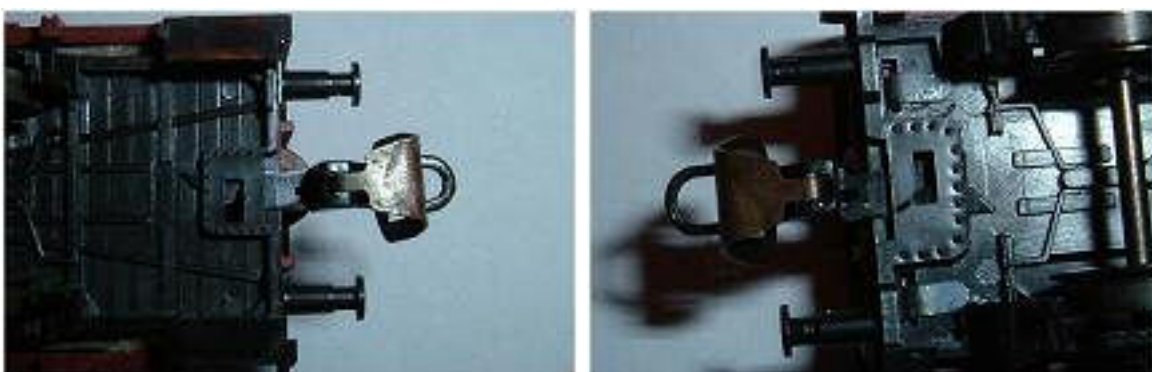
Obr. 44/45 - Upevnění spřáhel BTTB na dvouosém vagonu
