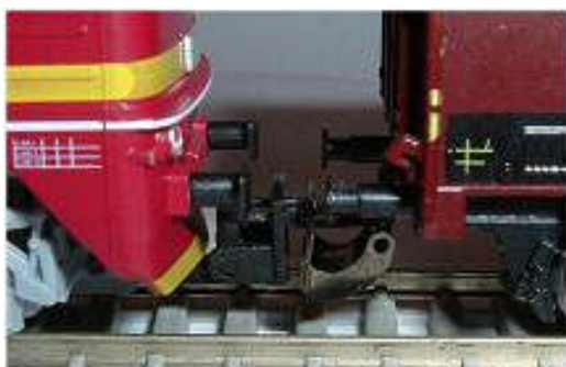
Obr. 154 - Tillig loko + Detail (st.) Vzdálenost nárazníků 3,0 / 4,0 mm
