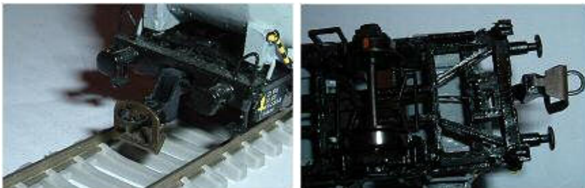
Obr. 183/184 - Upevnění spřáhla BTTB pomocí držáku ze zničeného vozu (pohled zepředu a zespodu)
