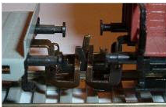
Obr. 11 - Spřažená dvojice spřáhel Zeuke
