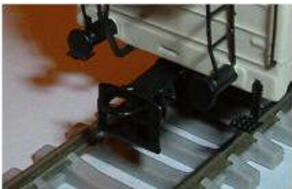
Obr. 93/94 - Spřáhlo DK Model na vagonu Lp (čtyřosé provedení, kinematika je umístěna uvnitř vozu)
