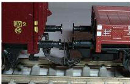
Obr. 158 - Detail (nov.) + Tillig Vzdálenost nárazníků 2,5 / 3,5 mm
