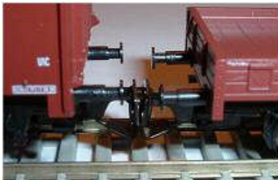
Obr. 100 - Spřažená dvojice spřáhel Tillig s kinematikou
