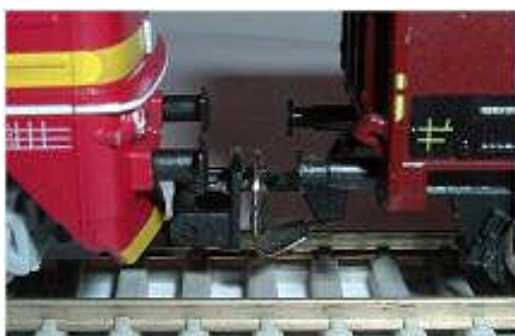
Obr. 148 - Tillig loko + BTTB Vzdálenost nárazníků 4,5 / 5,5 mm
