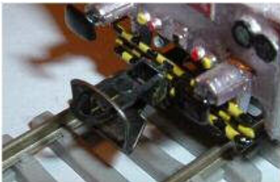
Obr. 207/208 - Upevnění spřáhla na lokomotivě řady 772 ŽSR (pohled zepředu a zespu)
