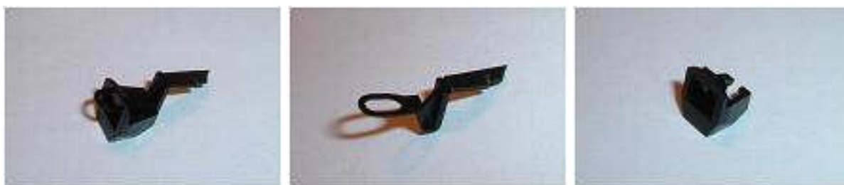
Obr. 62/63/64 - Spřáhlo LPH Jičín, jeho pevná část a třmen
