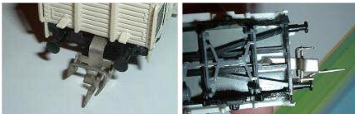
Obr. 13/14 - Ukázka principu upevnění průběžného spřáhla Zeuke
