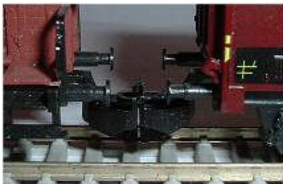
Obr. 67 - Spřažená dvojice spřáhel LPH Jičín
