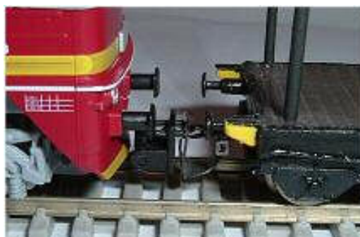
Obr. 163 - Tillig loko + Detail „D” Vzdálenost nárazníků 4,0 / 5,5 mm
