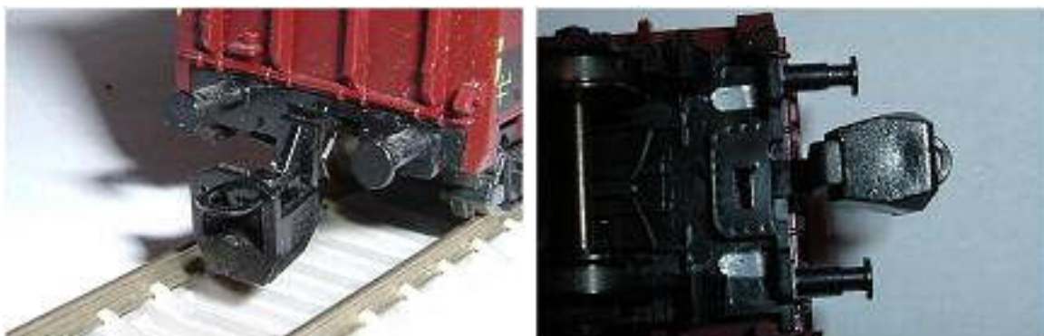
Obr. 65/66 - Vagon se spřáhlem LPH Jičín a jeho upevnění
