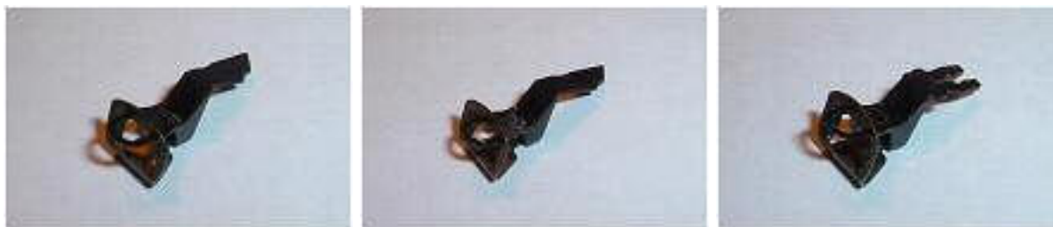
Obr. 34/35/36 - Spřáhla BTTB (s krátkým trnem, s dlouhým trnem a s trnem tvaru V)
