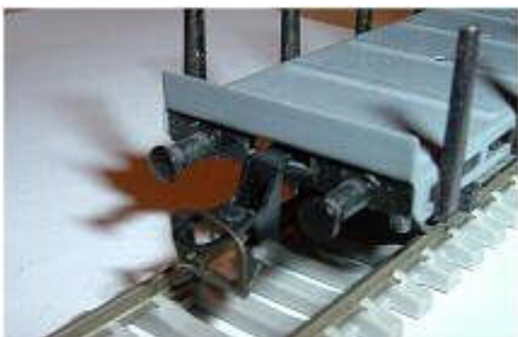
Obr. 181/182 - Ukázka náhrady průběžného spřáhla Zeuke upraveným spřáhlem BTTB (pohled zepředu a zespodu)
