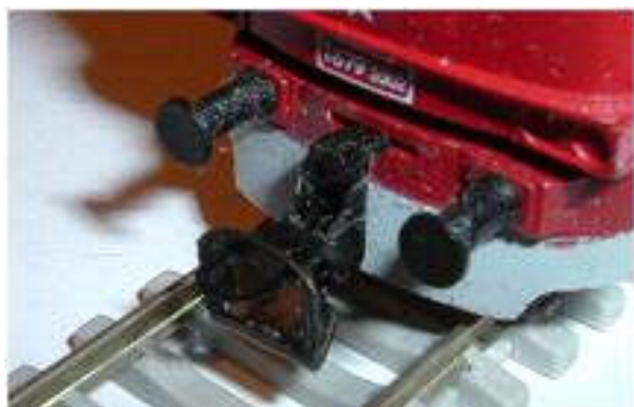
Obr. 51/52 - Spřáhlo BTTB s krátkým trnem na lokomotivách (221 DB a T 671)
