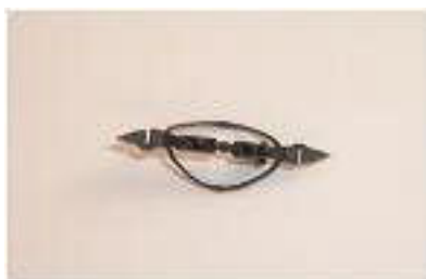
Obr. 130/131 - Pevné spřáhlo (délky 19 mm) a koncový hák p. Čambalíka
