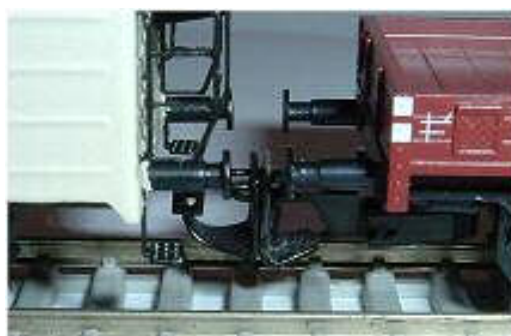
Obr. 165 - DK Model + Tillig Vzdálenost nárazníků 3,0 / 4,0 mm
