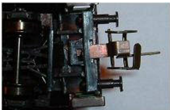
Obr. 23/24 - Upevnění spřáhla na čtyřosém vagonu
