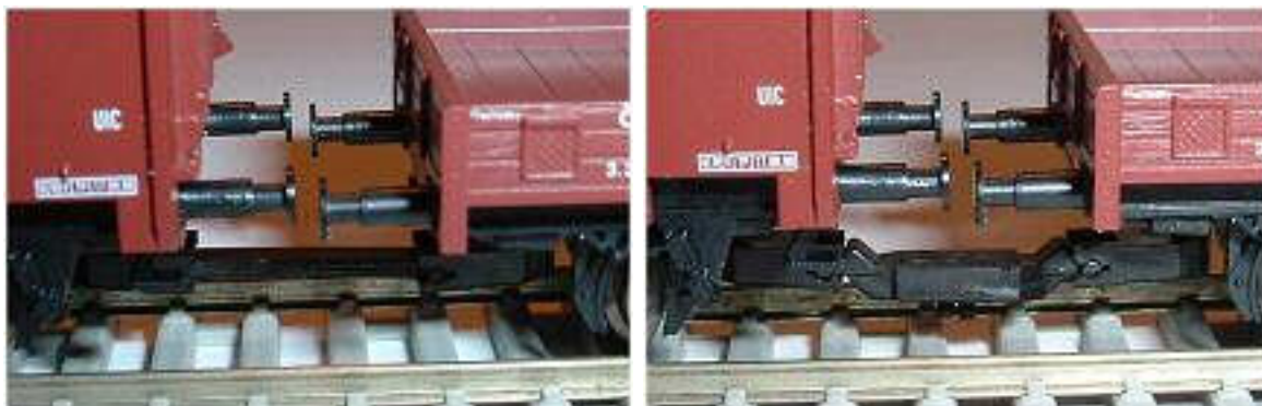
Obr. 102/104 - Spřažení pomocí pevné a rozpojitelné spojky s kinematikou
