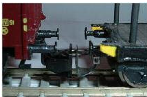
Obr. 161 - LPH + Detail „D” Vzdálenost nárazníků 5,0 / 7,0 mm
