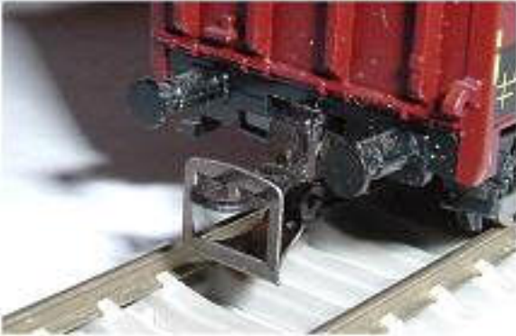
Obr. 80/81 - Spřáhlo Detail (nové provedení) na vagonu a jeho upevnění
