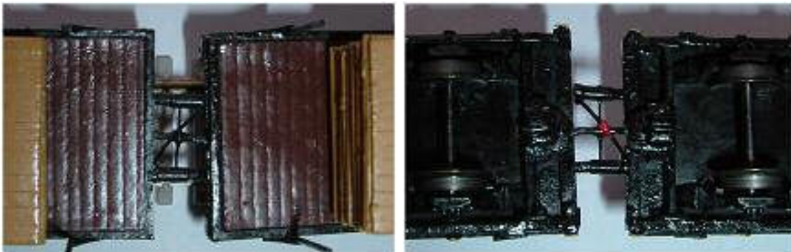
Obr. 199/200 - Pevné spojení vozů v jednotce Laas (pohled shora a zespodu)
