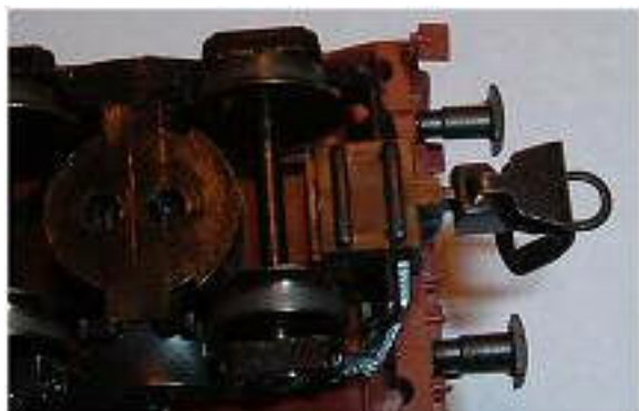
Obr. 49/50 - Spřáhlo do podvozku na vagonu a upevnění spřáhla v podvozku typu Y25
