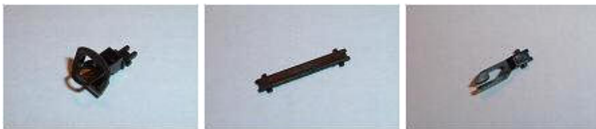
Obr. 97/98/99 - Spřáhlo Tillig, pevná spojka a jeden díl rozpojitelné spojky
