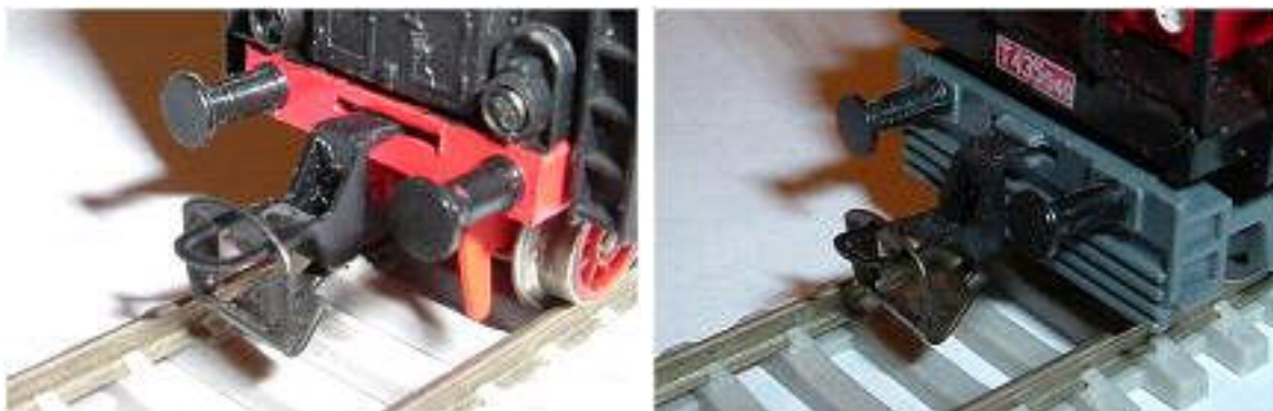
Obr. 53/54 - Spřáhlo BTTB s krátkým trnem na lokomotivách (455 a T 435)
