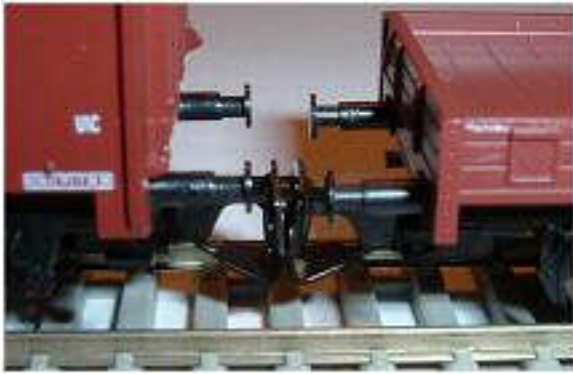
Obr. 100/101 - Ukázka spřažení dvojice spřáhel Tillig s kinematikou
