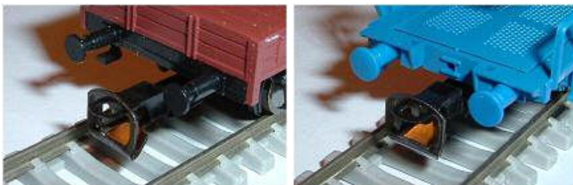
Obr. 108 - Ukázka principu funkce kinematiky (vychýlená poloha)
