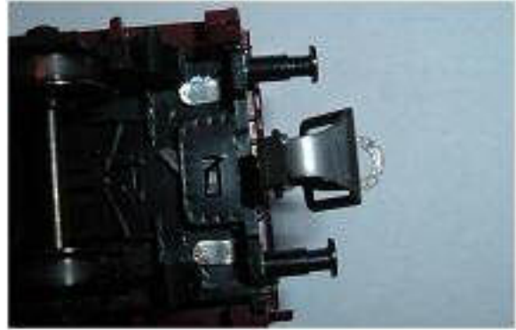
Obr. 80/81 - Spřáhlo Detail (nové provedení) na vagonu a jeho upevnění
