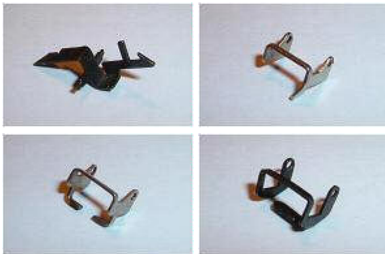
Obr. 7/8/9/10 - Pevná část spřáhla Zeuke a tři varianty provedení třmenu
