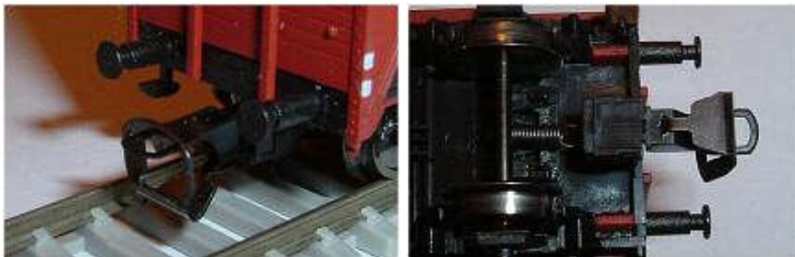
Obr. 134/135 - Spřáhlo (Tillig) upevněné v mechanismu Loco a pohled na jeho provedení
