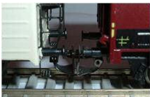
Obr. 156 - DK Model + Detail (nov.) Vzdálenost nárazníků 2,5 / 3,5 mm
