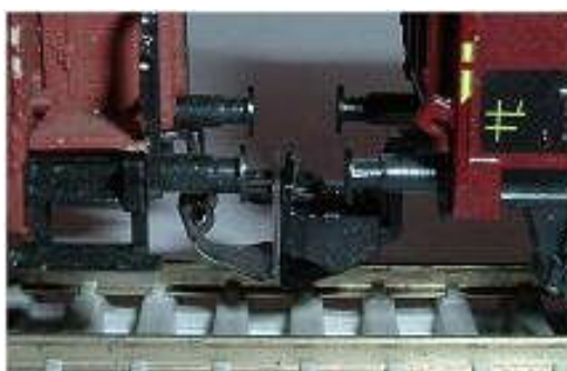
Obr. 157 - Detail (nov.) + LPH Vzdálenost nárazníků 4,0 / 6,0 mm
