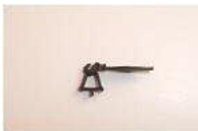
Obr. 130/131 - Pevné spřáhlo (délky 19 mm) a koncový hák p. Čambalíka
