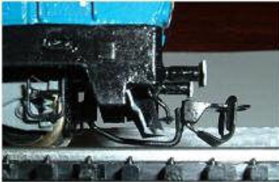
Obr. 205/206 - Upevnění spřáhla na lokomotivě T 499.0 (pohled z boku a celkový pohled na držák spřáhla)
