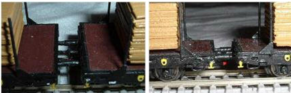
Obr. 197/198 - Pevné spojení vozů v jednotce Laas (pohled z nadhledu a z boku)
