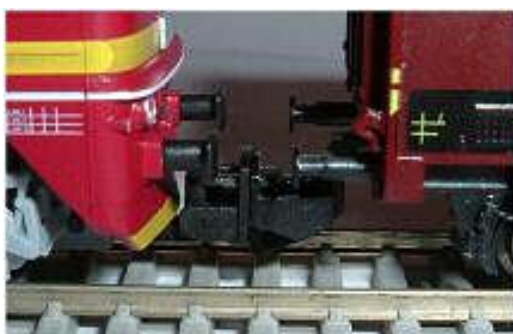
Obr. 168 - Tillig loko + LPH Vzdálenost nárazníků 5,0 / 6,5 mm
