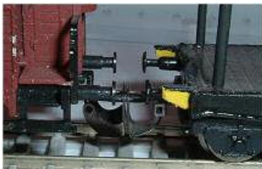
Obr. 150 - Detail (st.) + Detail „D” Vzdálenost nárazníků 3,5 / 4,5 mm
