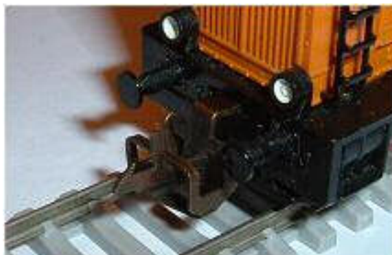
Obr. 28/29 - Upevnění spřáhla Zeuke na lokomotivách (nepohyblivé spřáhlo na loko E 499 a upevnění pomocí pružného drátku na loko V 36)
