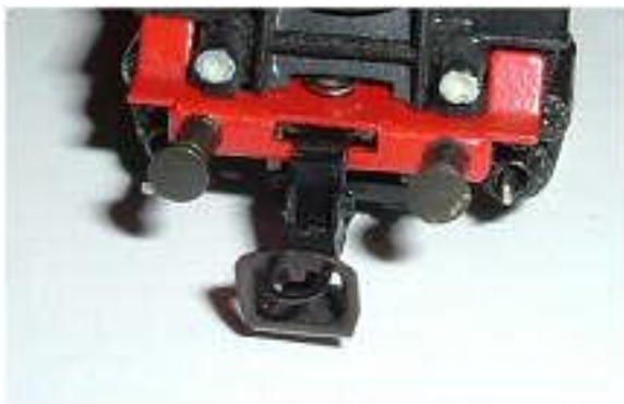
Obr. 172/173 - Spřáhlo BTTB osazené na původním otočném mechanismu upevnění spřáhla Zeuke
