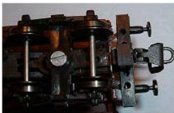
Obr. 128/129 - Spřáhlo BTTB upevněné v kinematice Peresvet na pracovním voze (se závěsem z ocelové struny)
