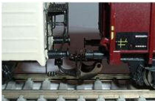
Obr. 151 - DK Model + Detail (st.) Vzdálenost nárazníků 3,0 / 3,5 mm
