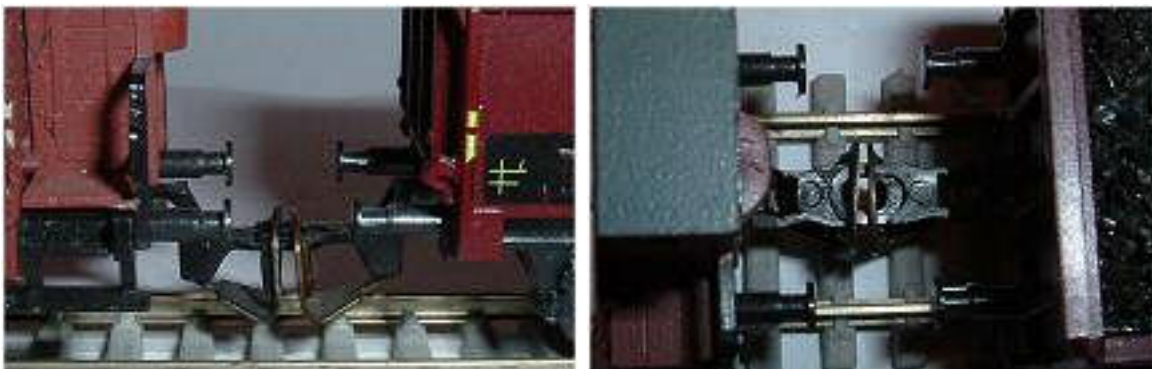
Obr. 40/41 - Ukázka spřažení dvojice spřáhel BTTB
