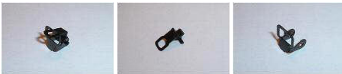
Obr. 123/124/125 - Spřáhlo Peresvet, jeho pevná část (obojí bez upevňovací části) a třmen
