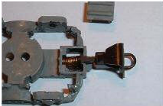
Obr. 48 - Princip upevnění spřáhla do podvozku
