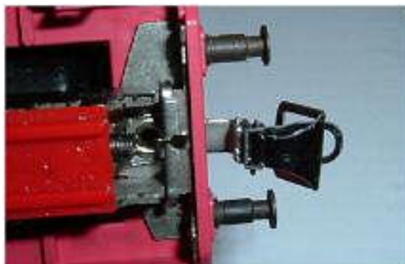
Obr. 174/175 - Spřáhlo Detail D osazené na původním otočném mechanismu upevnění spřáhla Zeuke
