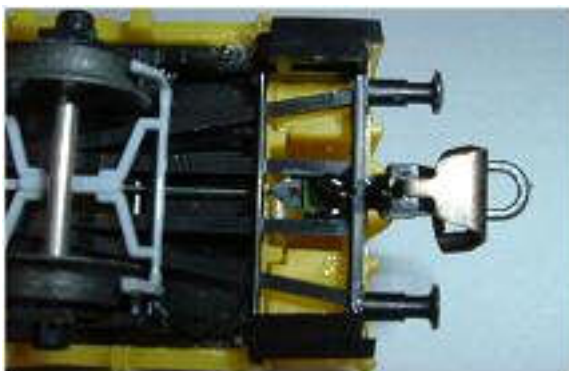
Obr. 177/178 - Ukázka náhrady průběžného spřáhla Zeuke upraveným spřáhlem BTTB (pohled zepředu a zespodu)
