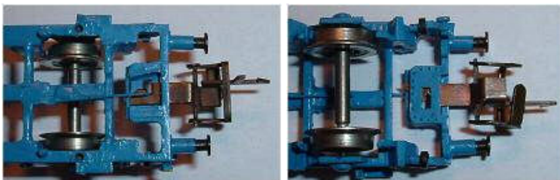
Obr. 15/16 - Ukázka principu upevnění spřáhla pomocí pružného drátku
