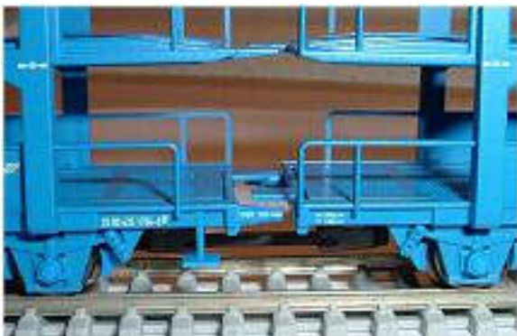
Obr. 106/107 - Ukázka spřažení dvojice vozů nakrátko v jednotce pro převoz automobilů
