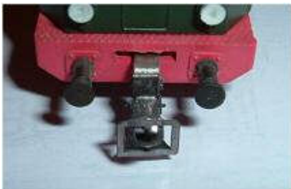
Obr. 174/175 - Spřáhlo Detail D osazené na původním otočném mechanismu upevnění spřáhla Zeuke
