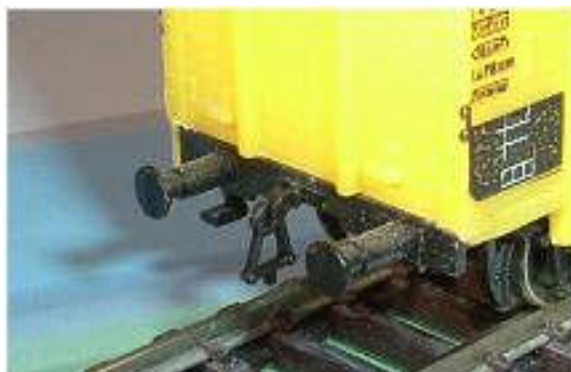
Obr. 132/133 - Vozy spřažené pevným spřáhlem a vůz vybavený imitací koncového háku
