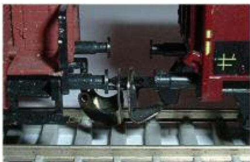
Obr. 142 - Detail (st.) + BTTB Vzdálenost nárazníků 4,0 / 5,5 mm
