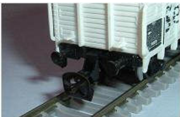
Obr. 179/180 - Ukázka náhrady průběžného spřáhla Zeuke upraveným spřáhlem BTTB (pohled zepředu a zespodu)
