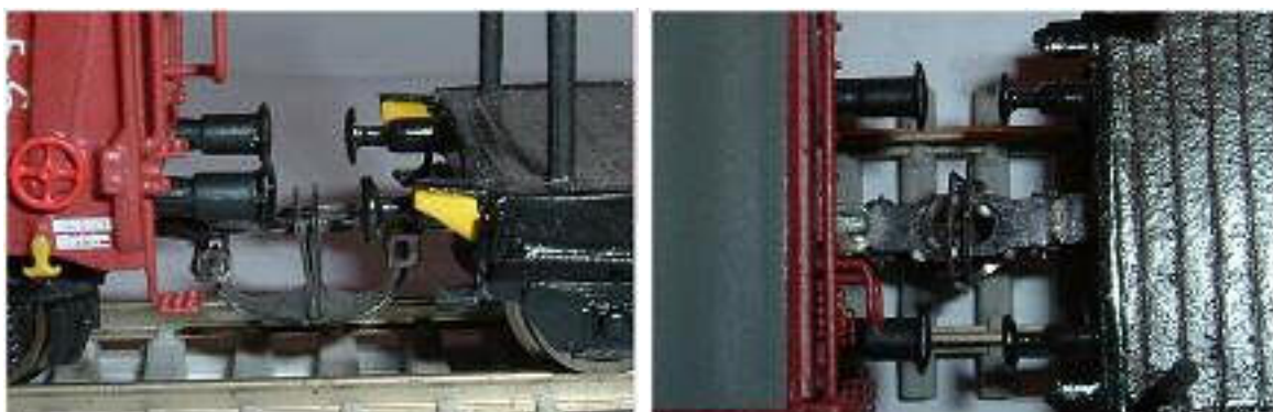
Obr. 87/88 - Ukázka spřažení dvojice „D“ spřáhel
