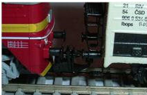
Obr. 166 - Tillig loko + DK Model Vzdálenost nárazníků 4,0 / 4,5 mm
