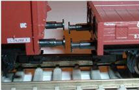
Obr. 102/103 - Ukázka spřažení pomocí pevné spojky s kinematikou
