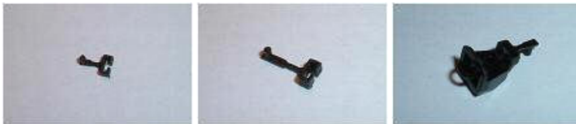
Obr. 137/138/139 - Držák spřáhel (krátké a dlouhé provedení) a spřáhlo LPH Jičín upevněné v držáku
