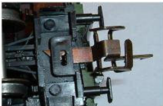
Obr. 25 - Upevnění spřáhla na rychlíkovém voze
