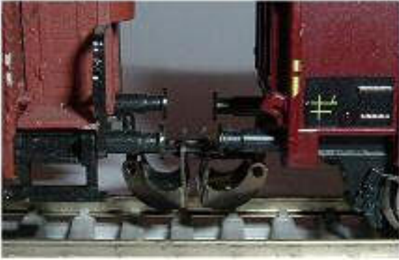
Obr. 78/79 - Ukázka spřažení dvojice spřáhel Detail (starší provedení)
