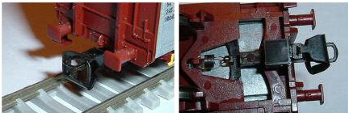
Obr. 121/122 - Spřáhlo upevněné v kinematice Roco a pohled na provedení kinematiky Roco
