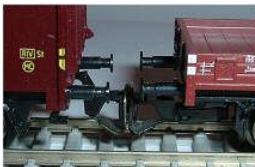
Obr. 147 - BTTB + Tillig Vzdálenost nárazníků 3,5 / 5,0 mm
