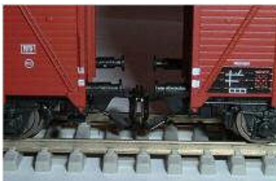
Obr. 136 - Ukázka spřažení spřáhel (Tillig) v mechanismu Loco
