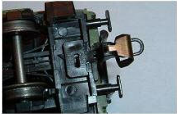
Obr. 46/47 - Spřáhlo BTTB s dlouhým trnem na vagonu a upevnění spřáhla BTTB na rychlíkovém voze
