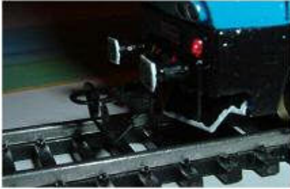
Obr. 203/204 - Upevnění spřáhla na lokomotivě T 499.0 (pohled zepředu a zespu)
