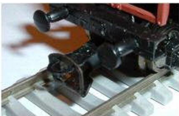
Obr. 128/129 - Spřáhlo BTTB upevněné v kinematice Peresvet na pracovním voze (se závěsem z ocelové struny)
