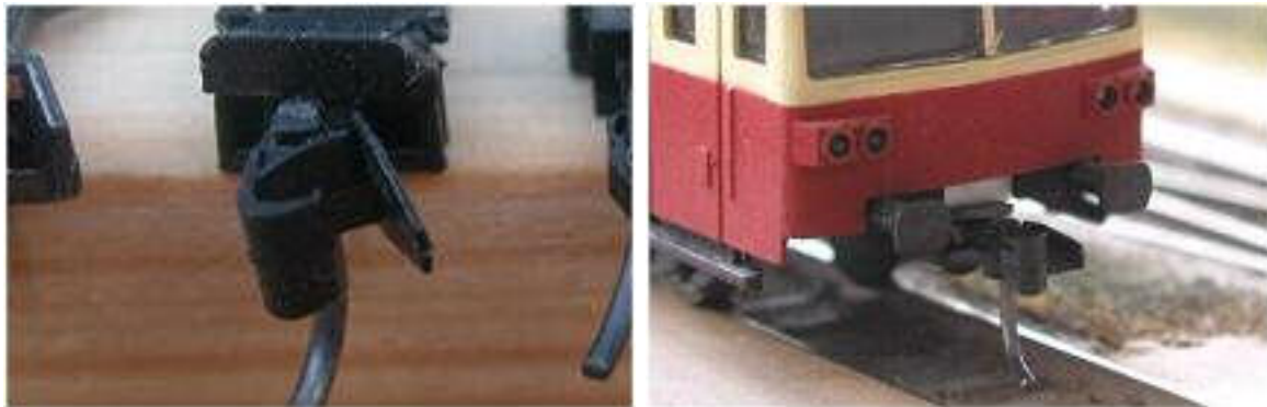
Obr. 140/141 - Spřáhlo Magne – Matic (Kadee 714) použitelné pro TT (foto poskytl ing.Petr Litomyský) a spřáhlo osazené na modelu (foto poskytl pan Vladimír Vacek)
