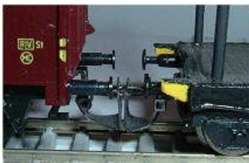
Obr. 155 - Detail (nov.) + Detail „D” Vzdálenost nárazníků 3,0 / 4,0 mm
