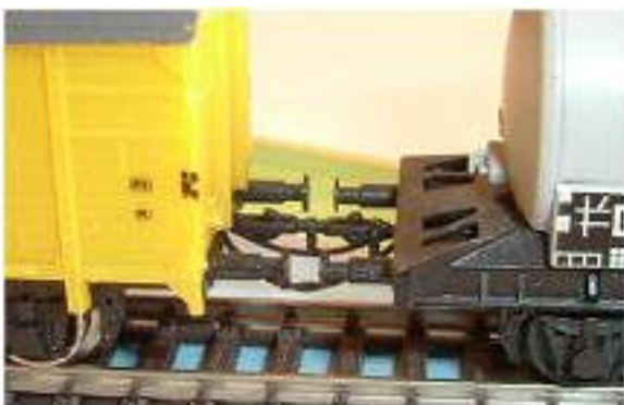
Obr. 132/133 - Vozy spřažené pevným spřáhlem a vůz vybavený imitací koncového háku
