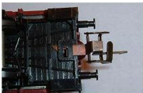
Obr. 19/20 - Upevnění spřáhla pomocí pružného drátku (starší a novější provedení rámu)
