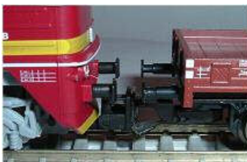
Obr. 169 - Tillig loko + Tillig Vzdálenost nárazníků 3,5 / 4,5 mm
