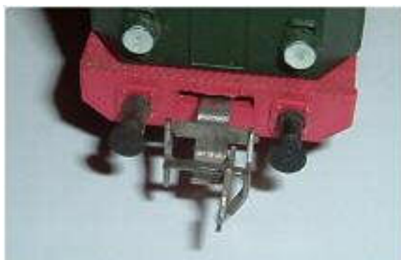
Obr. 26/27 - Původní otočné upevnění spřáhla Zeuke na lokomotivě E 70
