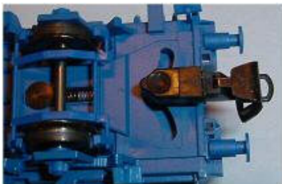
Obr. 114 - Ukázka provedení kinematiky na voze z jednotky pro převoz automobilů
