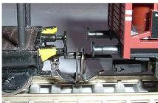
Obr. 162 - Detail „D” + Tillig Vzdálenost nárazníků 3,5 / 4,5 mm
