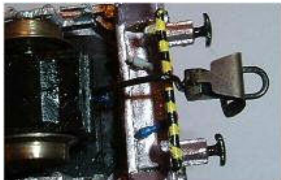
Obr. 207/208 - Upevnění spřáhla na lokomotivě řady 772 ŽSR (pohled zepředu a zespu)
