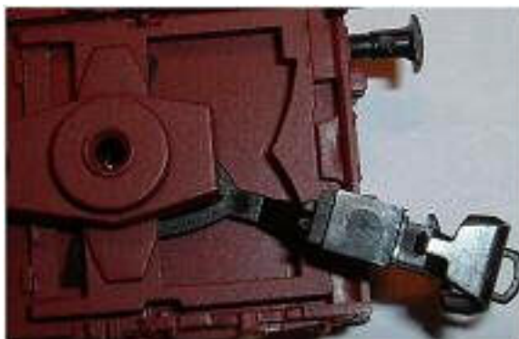
Obr. 108 - Ukázka principu funkce kinematiky (vychýlená poloha)
