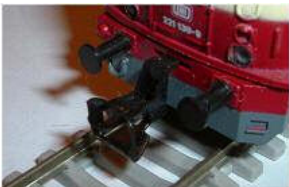
Obr. 51/52 - Spřáhlo BTTB s krátkým trnem na lokomotivách (221 DB a T 671)
