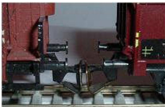
Obr. 40 - Spřažená dvojice spřáhel BTTB
