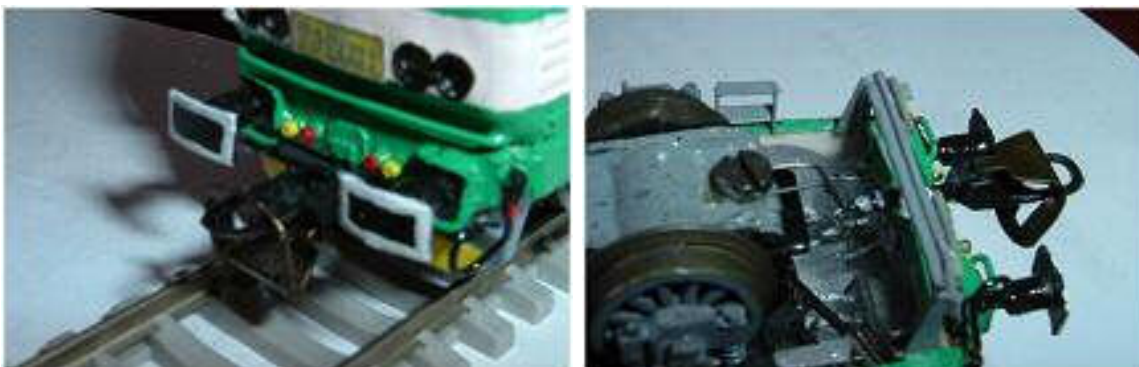
Obr. 210/211 - Upevnění spřáhla na lokomotivě výrobního označení 83 E používané u DNT (pohled zepředu a zespodu)
