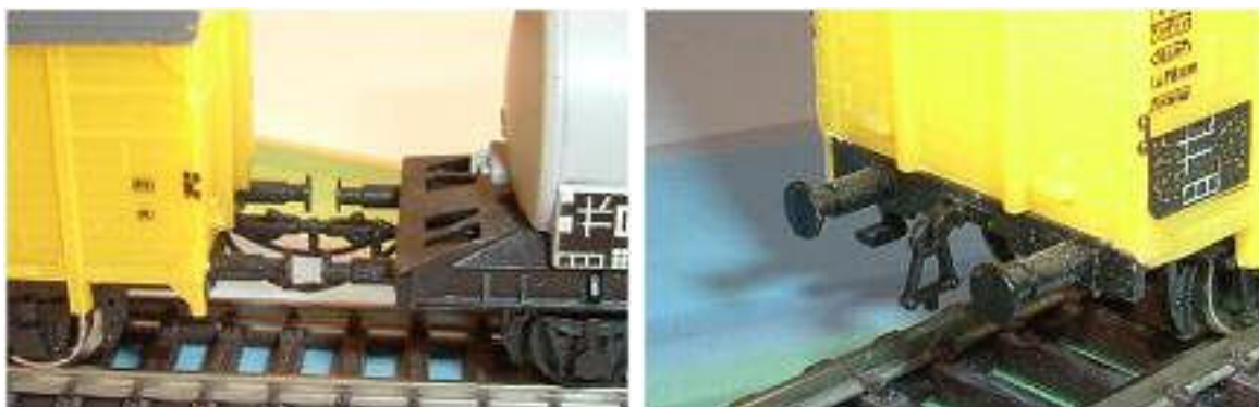
Obr. 132/133 - Vozy spřažené pevným spřáhlem a vůz vybavený imitací koncového háku
