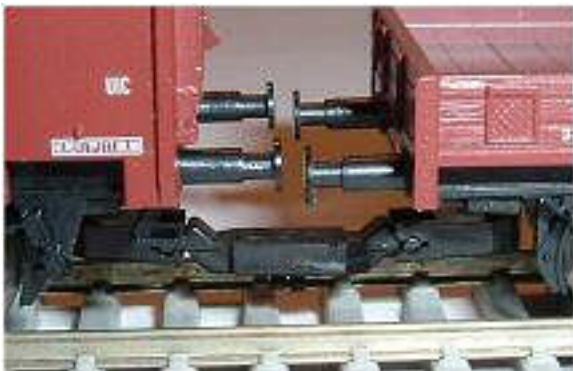
Obr. 104/105 - Ukázka spřažení pomocí rozpojitelné spojky s kinematikou
