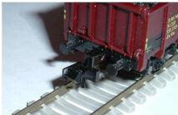
Obr. 58/59 - Spřáhlo ZPA Jičín na vagonu a jeho upevnění
