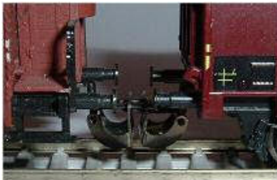
Obr. 78 - Spřažená dvojice spřáhel Detail (starší provedení)
