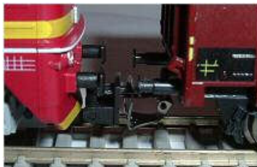
Obr. 159 - Tillig loko + Detail (nov.) Vzdálenost nárazníků 3,0 / 4,0 mm
