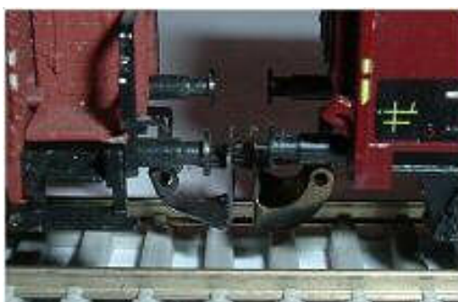
Obr. 149 - Detail (nov.) + Detail (st.) Vzdálenost nárazníků 2,5 / 3,5 mm
