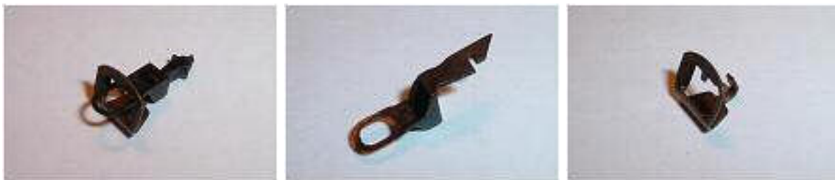
Obr. 37/38/39 - Spřáhlo BTTB pro upevnění do podvozku, pevná část a třmen spřáhla
