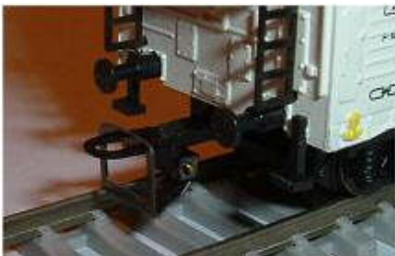
Obr. 126/127 - Spřáhlo Peresvet na chladícím voze Laghgrs s novým třmenem ze spřáhla Detail
