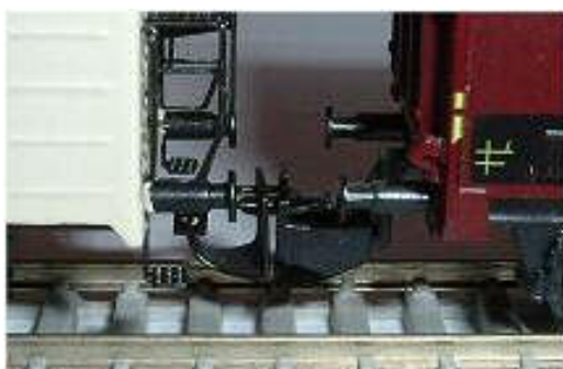
Obr. 164 - DK Model + LPH Vzdálenost nárazníků 5,0 / 6,0 mm
