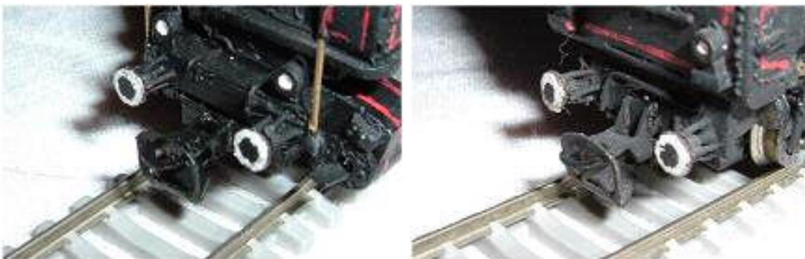
Obr. 201/202 - Nepohyblivé spřáhlo na lokomotivě 422.025 (přední a zadní čelo)
