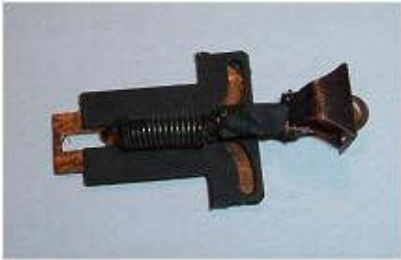
Obr. 89/90 - Spřáhlo DK Model s kinematikou (dvousé provedení) a spřáhlo na rozpracovaném vagonu Lgnss
