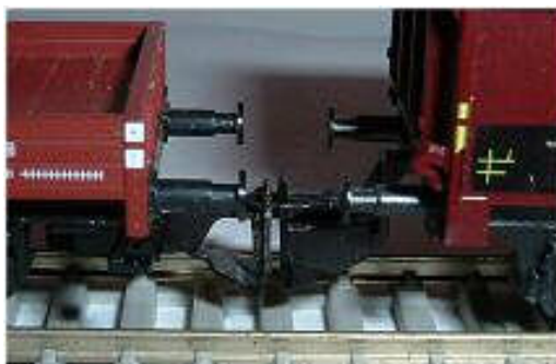
Obr. 167 - Tillig + LPH Vzdálenost nárazníků 4,0 / 6,0 mm
