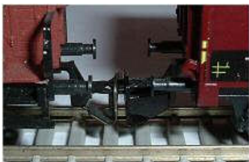
Obr. 146 - BTTB + LPH Vzdálenost nárazníků 5,0 / 7,0 mm
