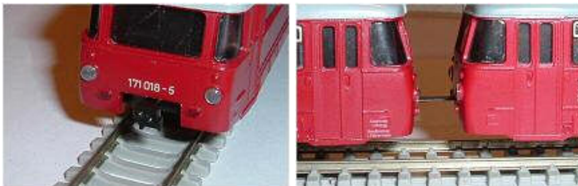
Obr. 32/33 - Motorový vůz s imitací automatického spřáhla a vozy spojené pevným spřáhlem
