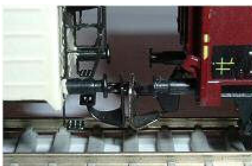
Obr. 145 - DK Model + BTTB Vzdálenost nárazníků 3,5 / 5,0 mm
