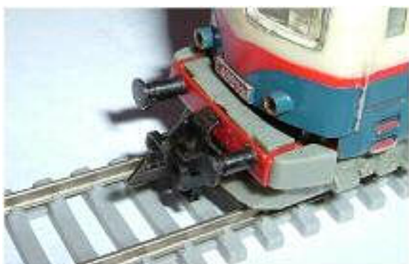
Obr. 28/29 - Upevnění spřáhla Zeuke na lokomotivách (nepohyblivé spřáhlo na loko E 499 a upevnění pomocí pružného drátku na loko V 36)
