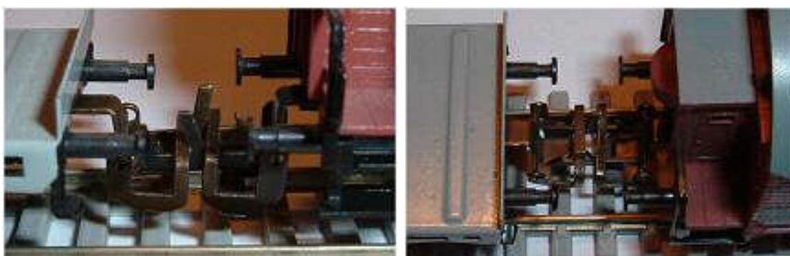
Obr. 11/12 - Ukázka spřažení dvojice spřáhel Zeuke
