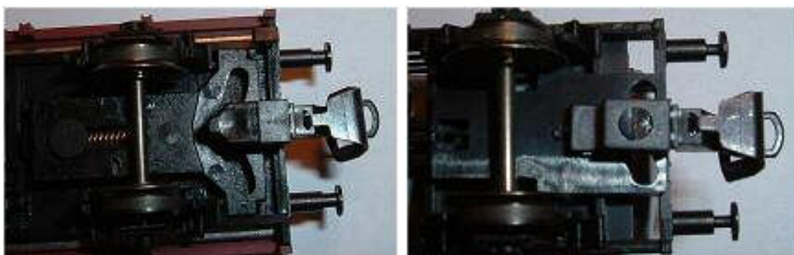
Obr. 112/113 - Ukázka provedení kinematiky na dvouosých nákladních vagonech (na obr 113 je ukázka kinematiky původního provedení firmy Jatt, jejíž produkci přebrala firma Tillig)
