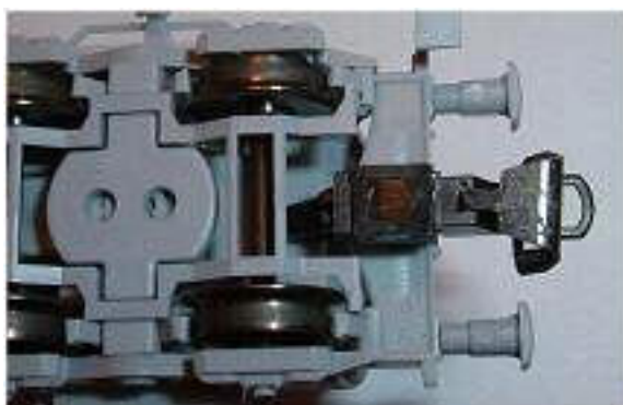
Obr. 115/116/117 - Ukázka několika provedení kinematiky na čtyřsých nákladních vagonech
