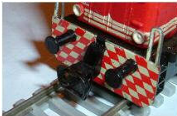
Obr. 170 - Spřáhlo BTTB osazené na čele lokomotivy T 334 místo původního spřáhla Zeuke
