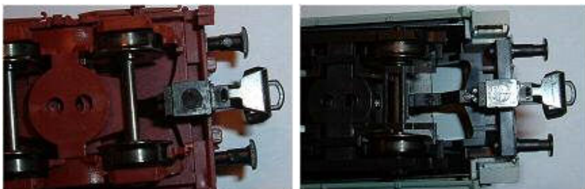
Obr. 114 - Ukázka provedení kinematiky na voze z jednotky pro převoz automobilů
