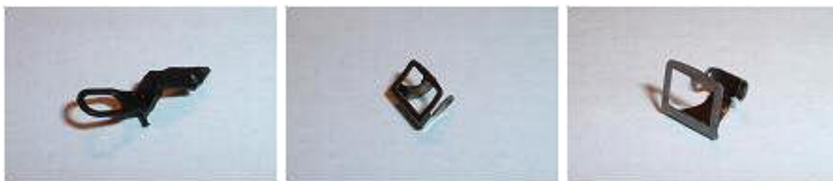
Obr. 71/72/73 - Pevná část spřáhla Detail, třmeny staršího a novějšího provedení
