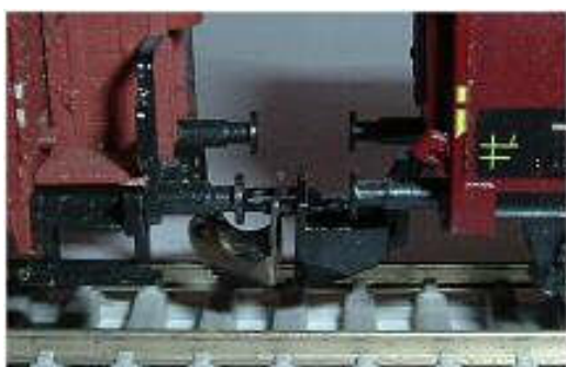
Obr. 152 - Detail (st.) + LPH Vzdálenost nárazníků 5,0 / 6,0 mm
