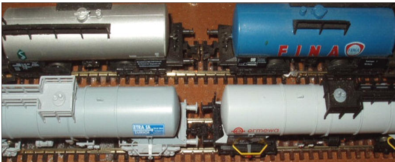
Ukázka rozdílu spojení pomocí klasických spřáhel a "krátkého" spojení.
