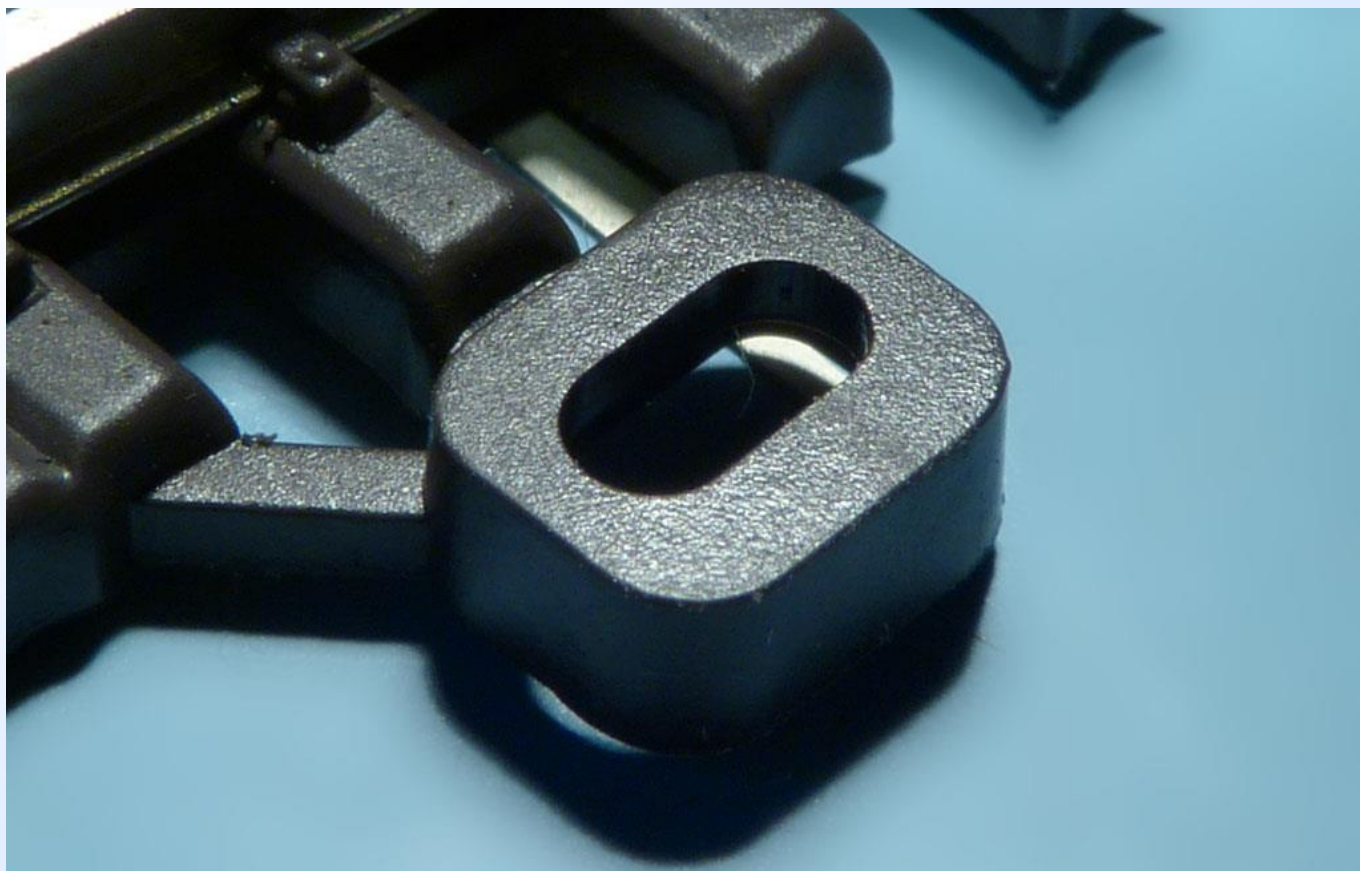
Obr. 7: Jeden z úchytů pro elektromagnetický přestavník.
