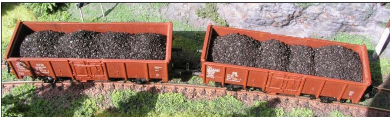
Obrázek 5 – Vlevo uhlí s polystyrenovým základem, vpravo náklad vyroben z továrního výlisku
