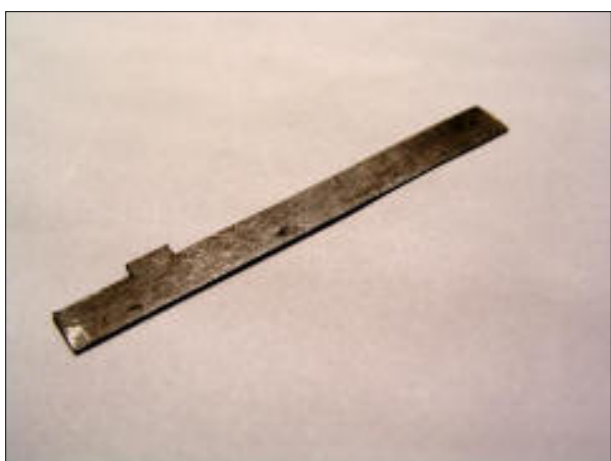
Obr.4 – Náhrada plíšku z ocelové planžety
