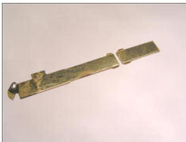
Obr.3 – Obě části rozlomeného plíšku
