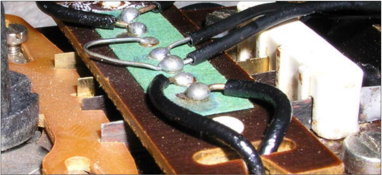
Obr.6 – Všechny čtyři plíšky na svém místě (po opravě)
