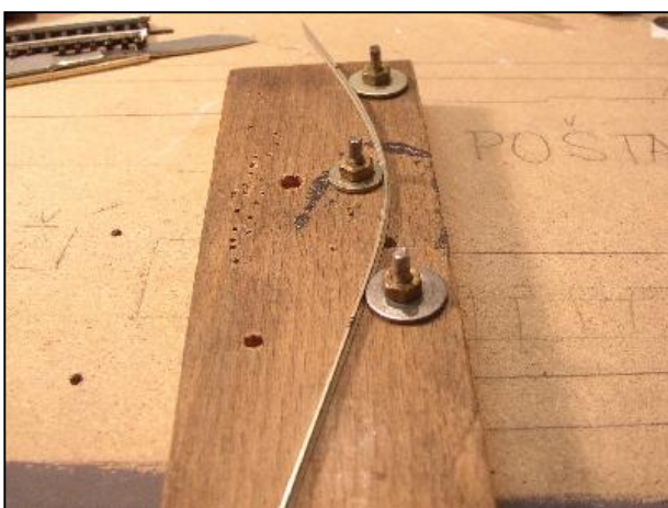
Obr.2 – Ohnutí koleje přibližně na R 90 mm
