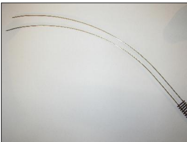
Obr.4 – Finálně ohnutá kolej před navlečením pražců
