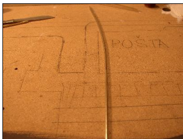
Obr.3 – Prut se po vyjmutí opět částečně narovnal
