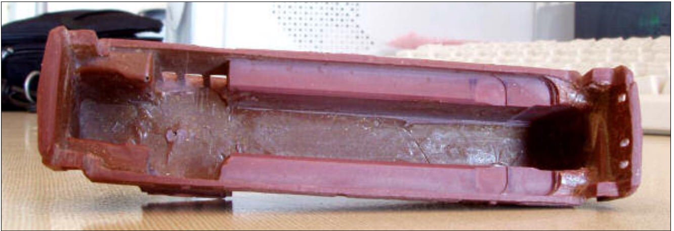
Obr.E2 – Pohled na ořezovanou dosedací plochu odlitku
