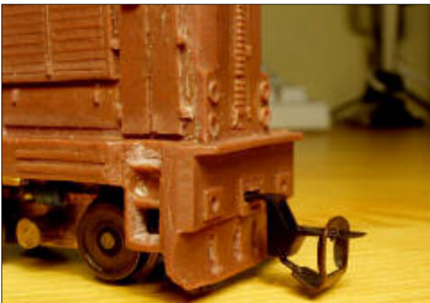
Obr.E3 - Detailní pohled na upevnění spřáhla
