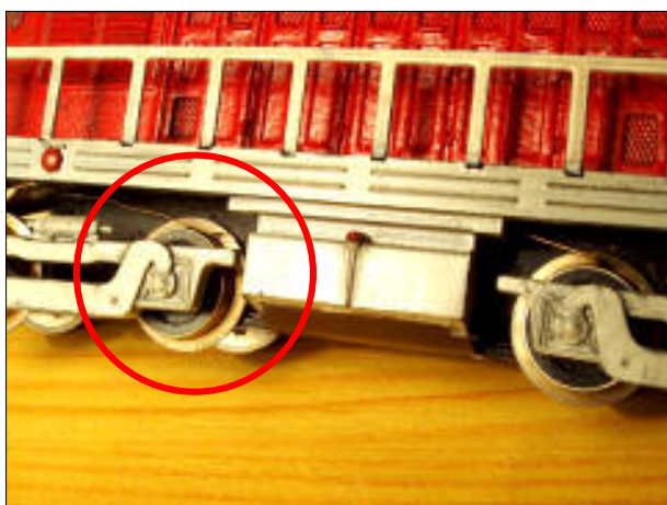
Obr.A1 – Vlevo – přídavný sběrač přiléhá na kolo
