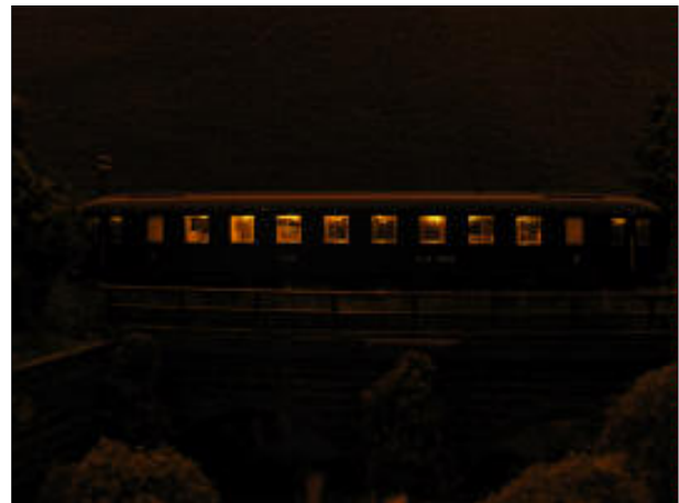
Obr.14 - Ukázka svítivosti LED s 1,8 mm čočkou
