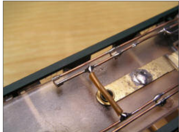
Obr.12 - SMD diody na zvonkovém drátu
