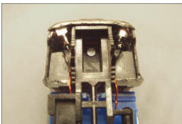
Obr.7 – Spodní pohled na nainstalované diody
