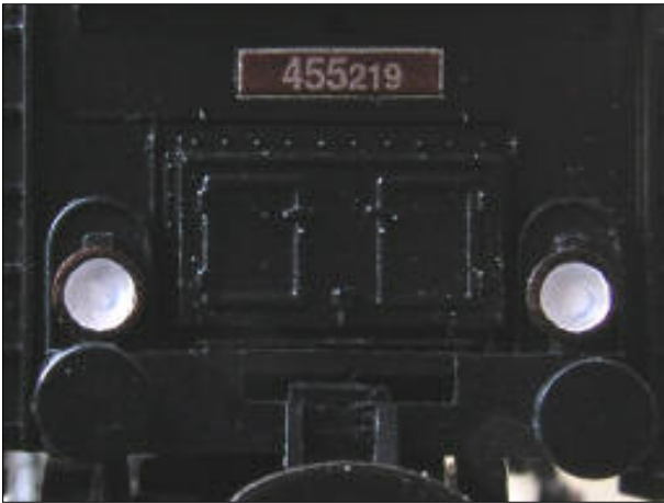
Obr.11 – Vnitřek zadních světel po natření bílou barvou
