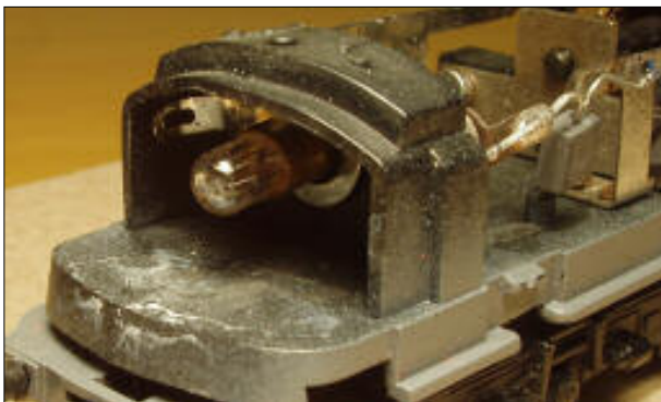
Obr.1 – Původní žárovkové osvětlení
