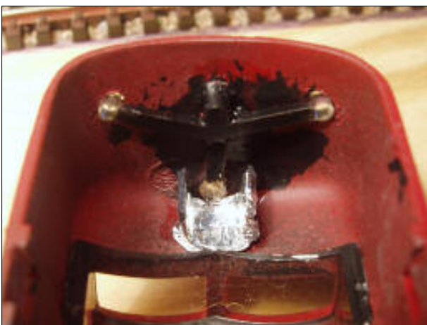
Obr.5 – Světlovod a stínítko reflektoru
