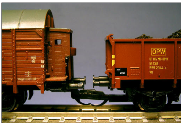
Obr.7 – Vůz s upraveným spřáhlem a vůz s kinematikou (přibližně 3 mm)
