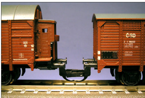
Obr.5 – Dva vozy s původními spřáhly (8 mm)
