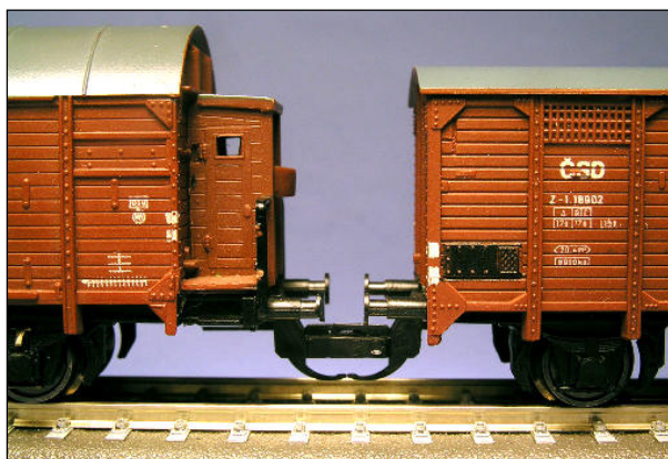
Obr.6 – Dva vozy s upravenými spřáhly (3,4 - 4 mm)
