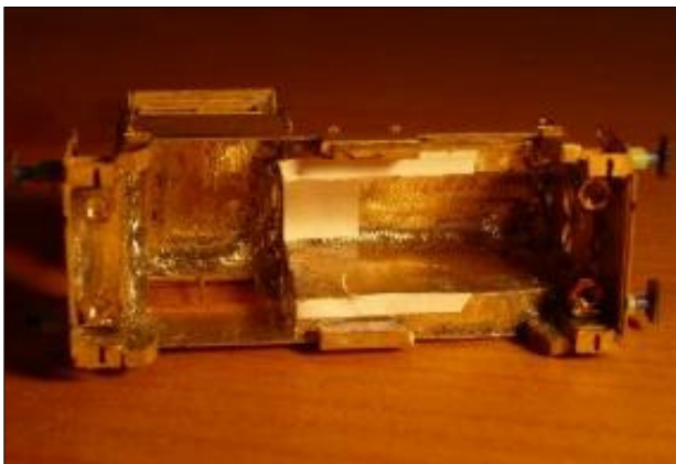
Obr.18 – Pohled do vyfrézované skříně modelu
