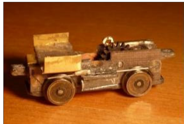
Obr.7 – Zkompleťovaný rám s dvojkolími
