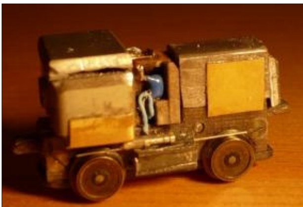
Obr.12 – Kompletní pojezd i se závažím zprava
