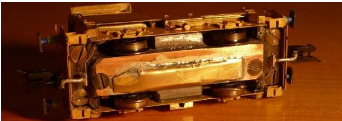
Obr.20 – Pohled na spodek modelu včetně detailů mechanismu pro natáčení a středění spřáhel
