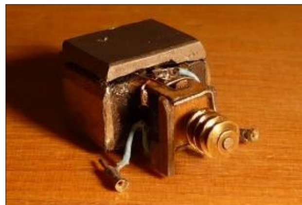
Obr.9 – Upravený motor s připevněným závažím
