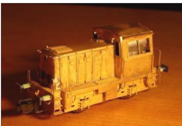
Obr.21 – Pohled na hotovou stavbu modelu bez nátěru
