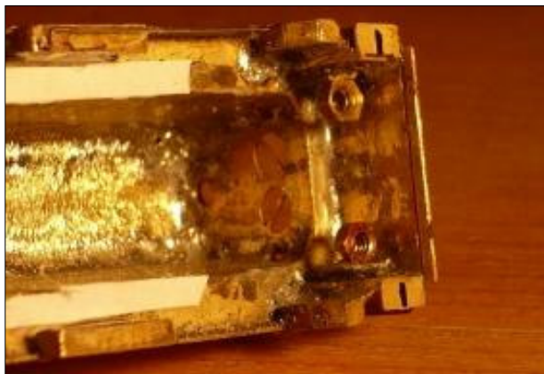
Obr.19 – Detail upevnění matic pro připevnění pojezdu
