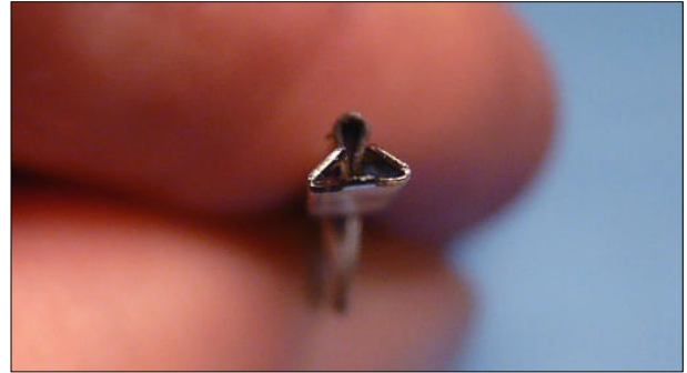
Obr.6 – Spojka nasunutá na plechovou kolejnici
