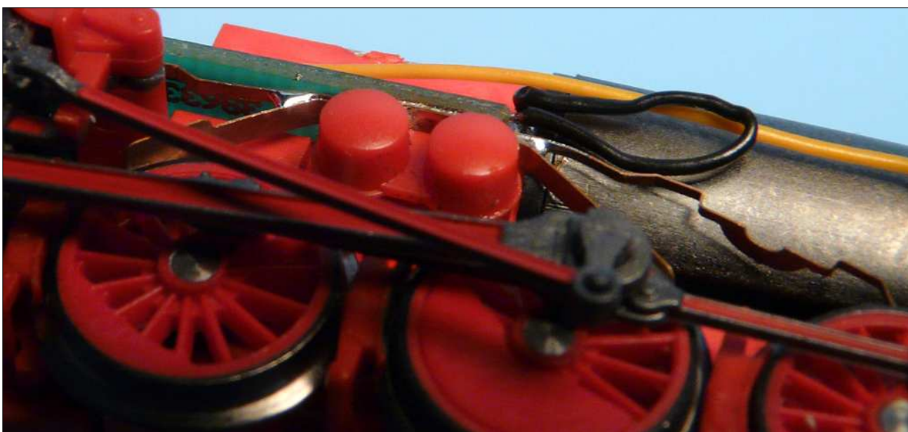
Obr.9 – Nový sběrač jsem zasunul mezi plošný spoj a sběrače vnitřních náprav a opatrně zakápnul cínem.
