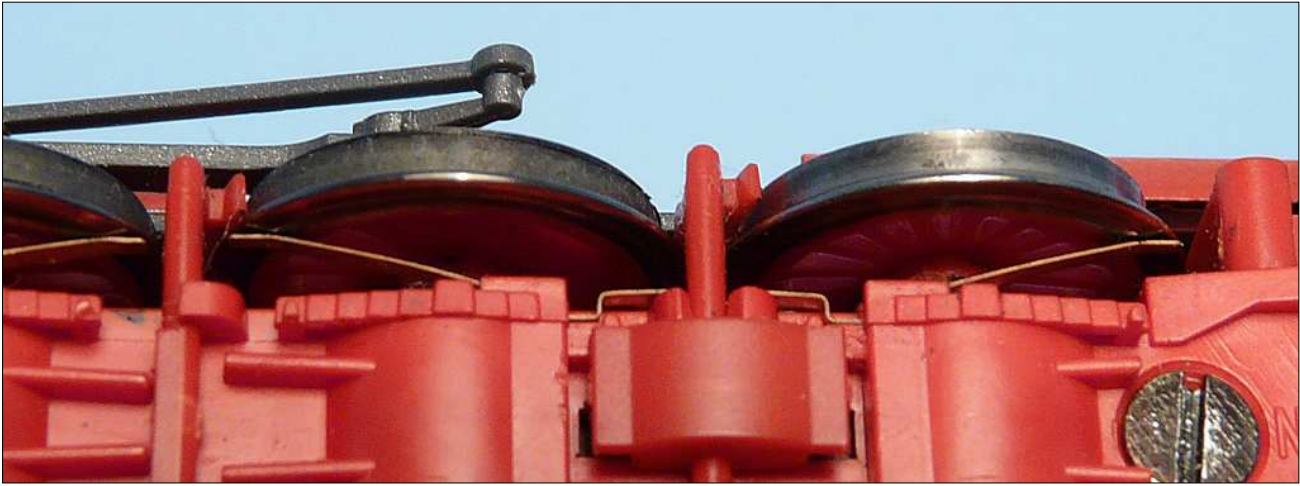
Obr.3 – Propojení krajních náprav s vnitřními.
