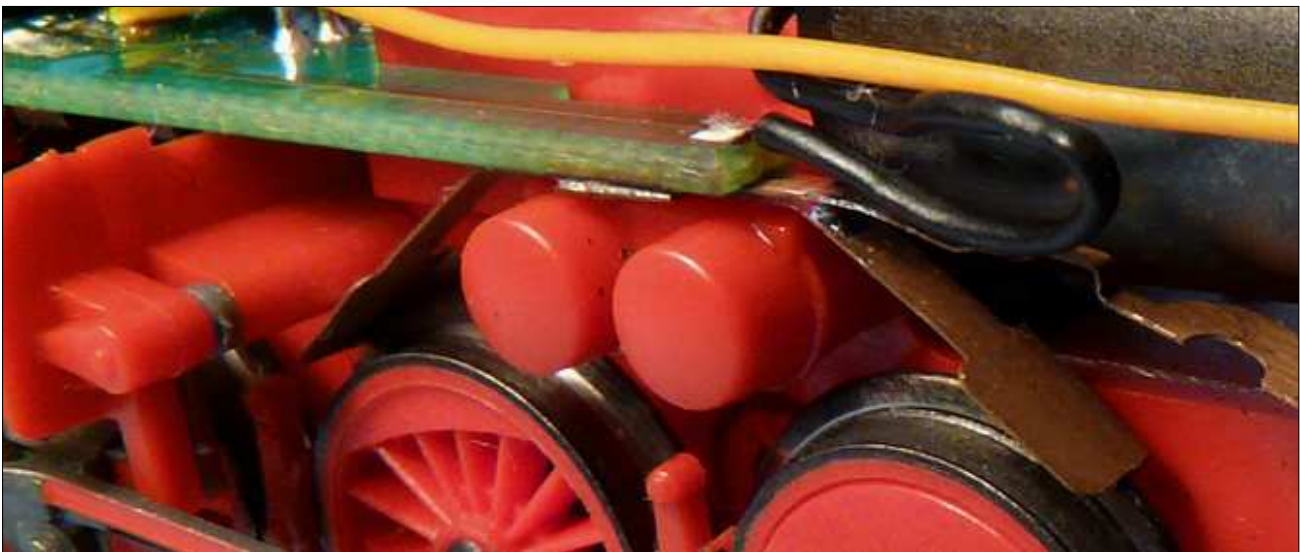
Obr.4 – Sběrače na vnitřních nápravách.
