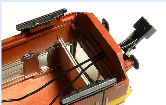
Obr.10: Kablíky jdou do vnitřku vozu štěrbinou pro spřáhlo.
