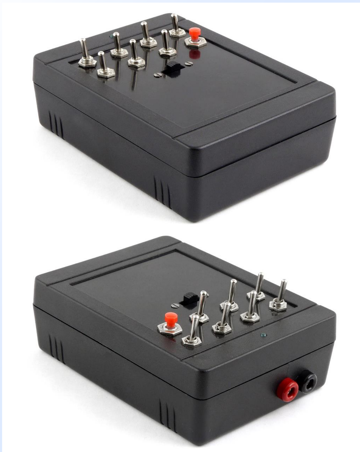
Obr. 4 a 5: Hotový panel z obou stran. Na výstupu jsem použil zdířky na banánky.
