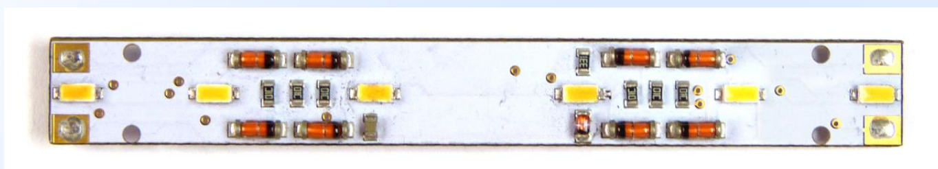
Obr. 1: Spodní strana DPS se šesti ledkami. V rozích jsou patrné napájecí kontakty.
