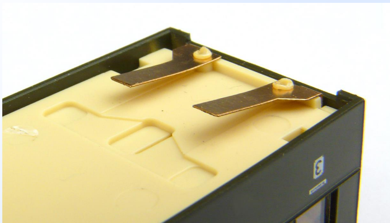
Obr. 6: Původní podoba spodní části plíšků, která se dotýká ložisek dvojkolí. Konce plíšků se opírají o rám a ne vždy doléhají.
