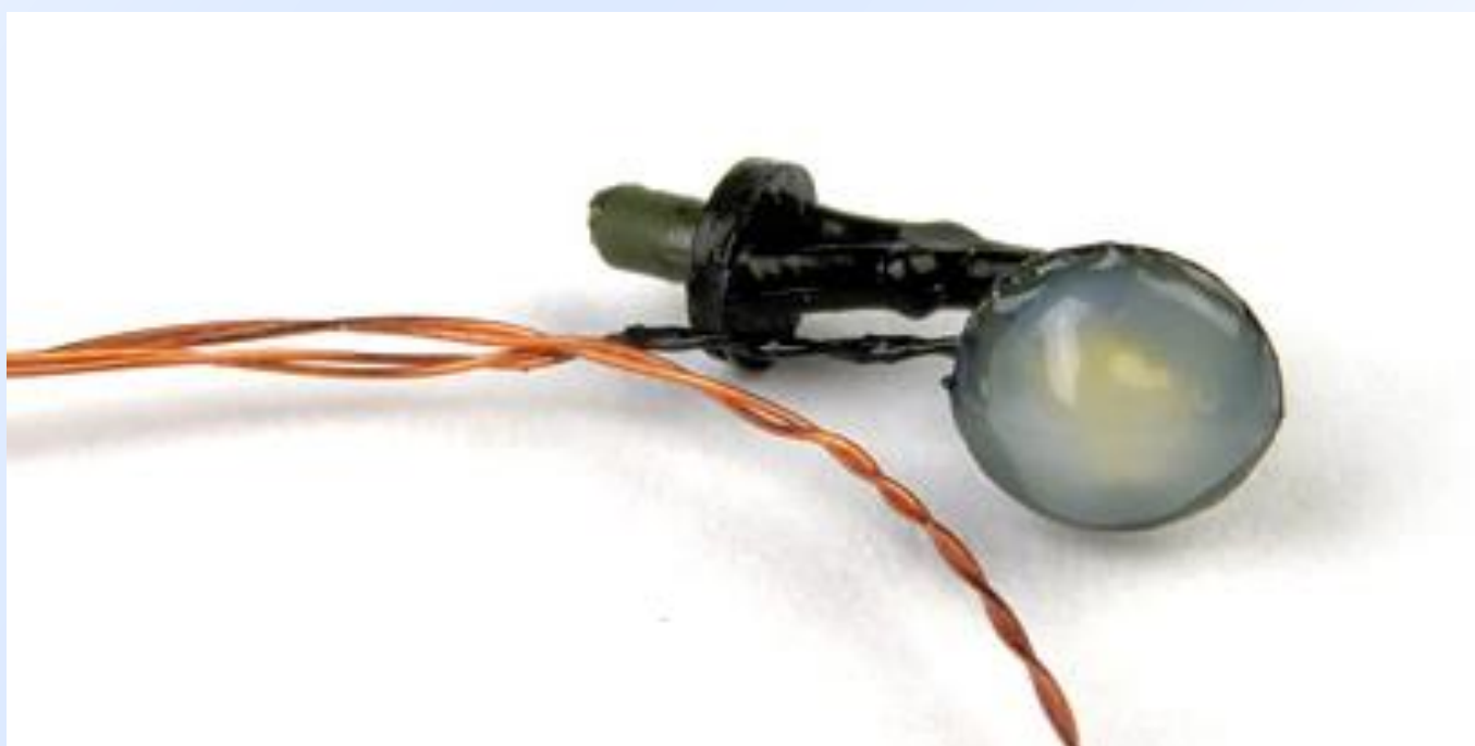
Obr. 6: Lepidlo po zaschnutí (2 vrstvy).
