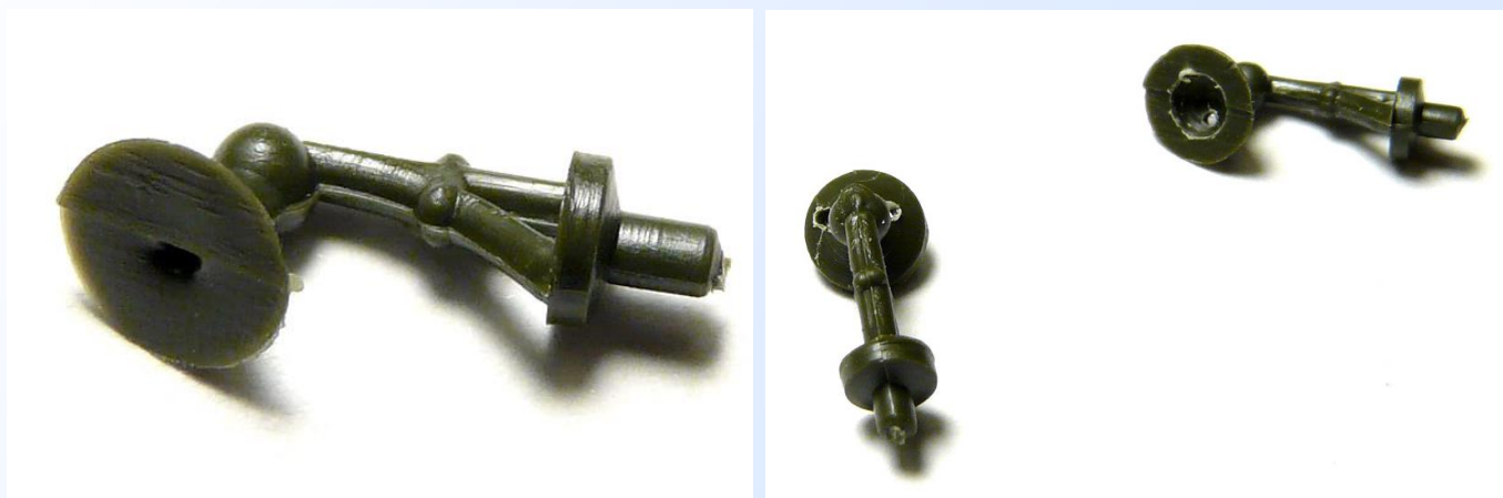
Obr. 2 a 3: Vlevo původní konzola, vpravo konzoly s vyvrtanou prohlubní pro ledku a otvory pro kablíčky.
